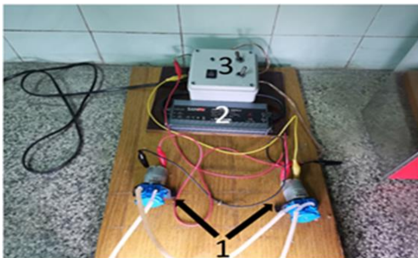
Slika 13. Prikaz dijelova fotoreaktora, 1. Peristaltičke pumpe, 2. Transformator, 3. Sklopka
