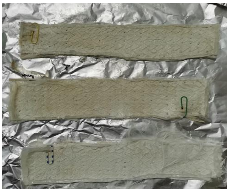
Slika 12. Prikaz staklene mrežice sa imobiliziranim \text{TiO}_2 slojem
