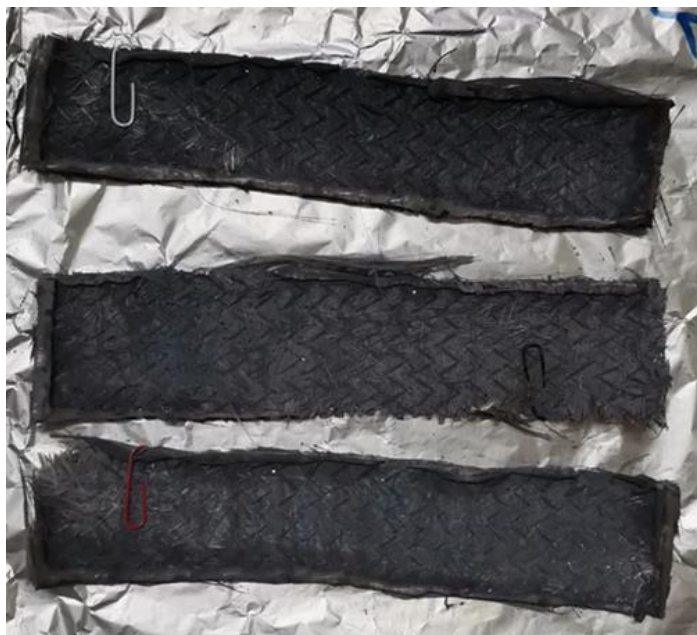
Slika 13. Prikaz staklene mrežice sa imobiliziranim TiO 2 slojem + grafen oksid
