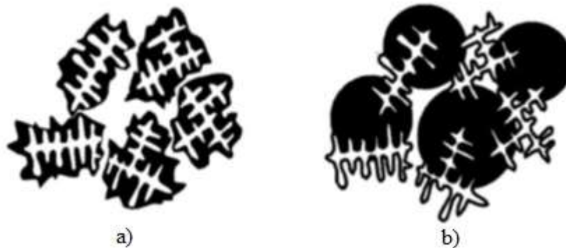
Slika 29. Shematski prikaz nastajanja eutektika prema postojećim mehanizmima
