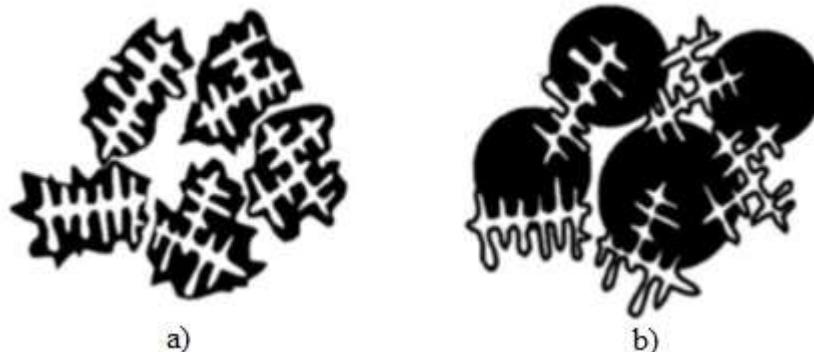
Slika 29. Shematski prikaz nastajanja eutektika prema postojećim mehanizmima
