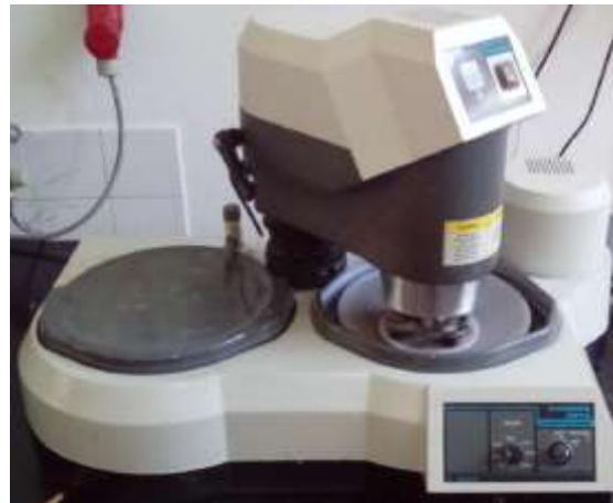
Slika 46. Uređaj za brušenje i poliranje Vector LC
