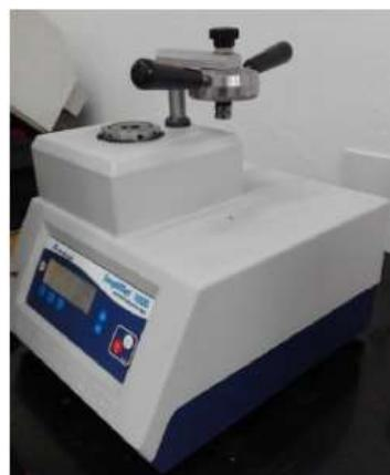
Slika 45. Uređaj za zaliđevanje uzorka SimpliMet 1000
