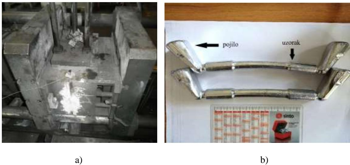
Slika 42. Lijevanje AlSi12 legure nakon pripreme i obrade taline:
