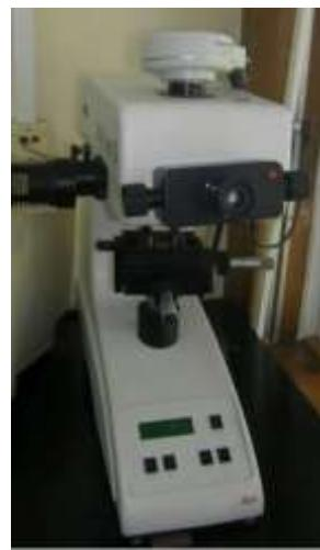
Slika 50. Mikrotvrdomjer Leica VMHR [43]
