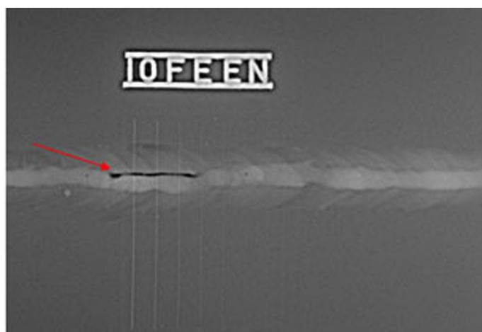
Slika 9. Oštećenje uočeno radiografskim ispitivanjem [24]
