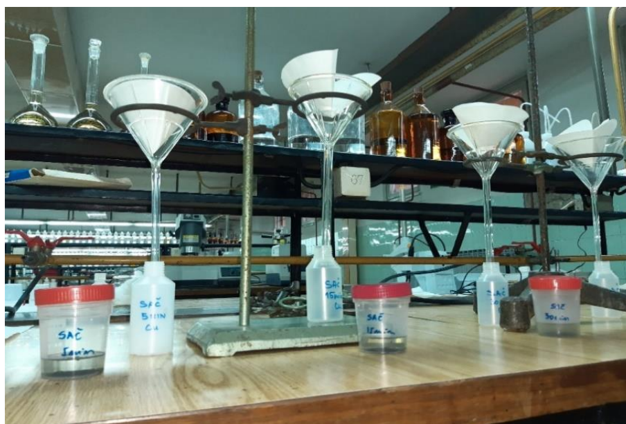
Slika 6. Provođenje adsorpcijskog eksperimenta
