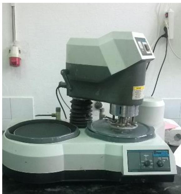
**Slika 19.** Uredaj za brušenje i poliranje Buehler „Phoenix beta“
