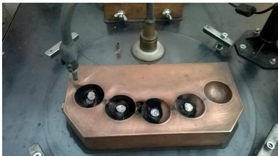
**Slika 15.** Taljenje uzoraka električnim lukom u bakrenom kalupu
