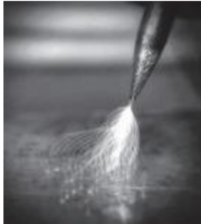
Slika 3. Fotografija uspostave električnog luka visokofrekventnim generatorom [12]
