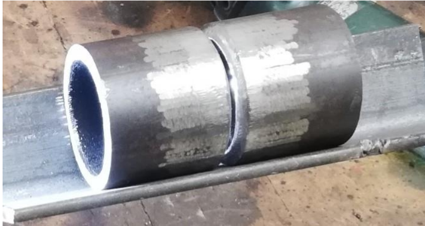
Slika 9. Fotografija pripremljenog osnovnog materijala za zavarivanje
