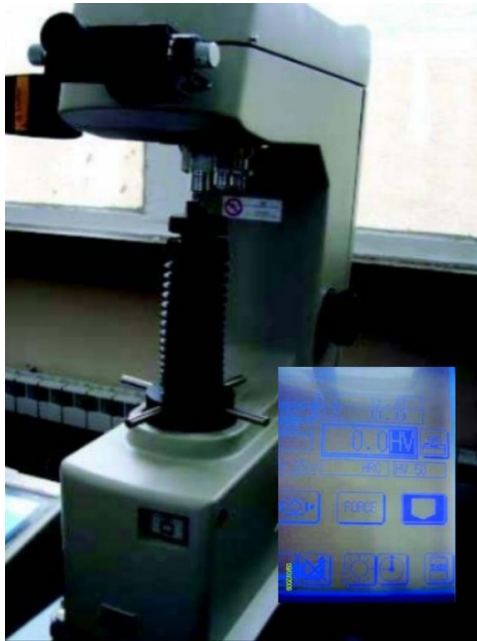
Slika 24. Vickersov tvrdomjer za mjerenje SMA legura [32]
