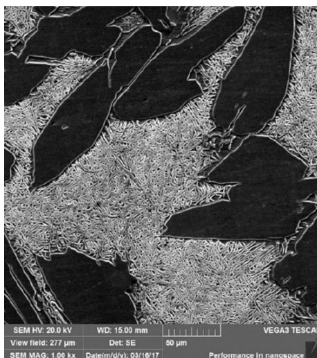
Slika 41. SEM mikrofotografija Cu10Al8Mn4Ag legure nakon homogenizacije i sporog hlađenja
