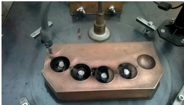
Slika 21. Uzorci Cu-Al-Mn legura nakon pretaljivanja 5x
