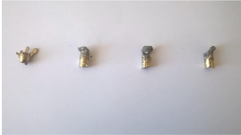
Slika 23. CuAlMn legura pripravljena taljenjem u elektrolučnoj peći i lijevanjem u kalup
