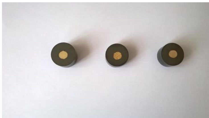
Slika 28. Nagriženi uzorci Cu-SMA legura
