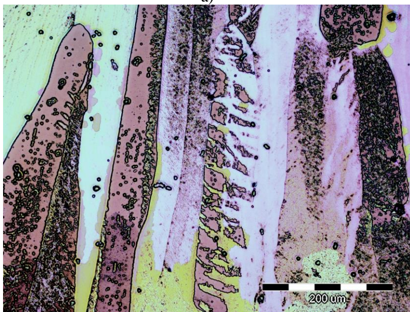
Slika 26. Snimljene mikro-strukture, a) u površinskom dijelu i b) centralni dio uzorka nakon ostvarenih 46 % redukcije
