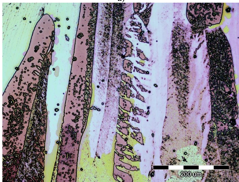
Slika 26. Snimljene mikro-strukture, a) u površinskom dijelu i b) centralni dio uzorka nakon ostvarenih 46 % redukcije
