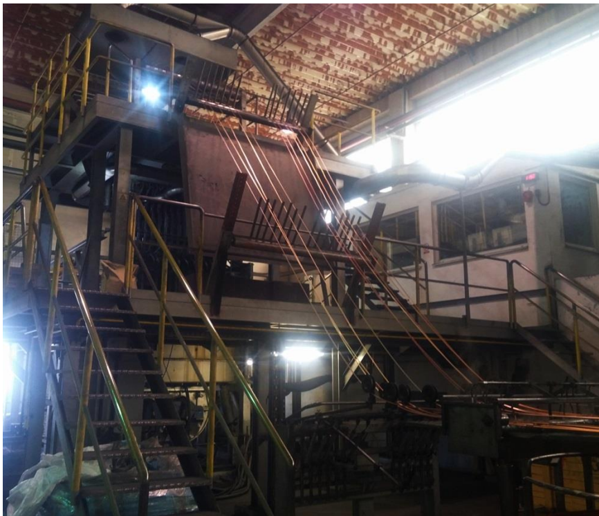
Slika 5. Povlačenje žice prema kolutovima
