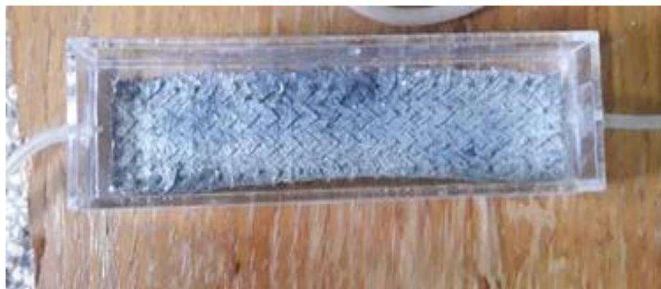
**Slika 16.** Reaktor za ispitivanje fotokatalitičke aktivnosti
