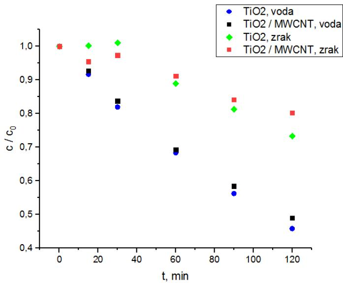
**Slika 28.** Ispitivanje fotokatalitičke aktivnosti imobiliziranih fotokatalizatora, početak eksperimenta
