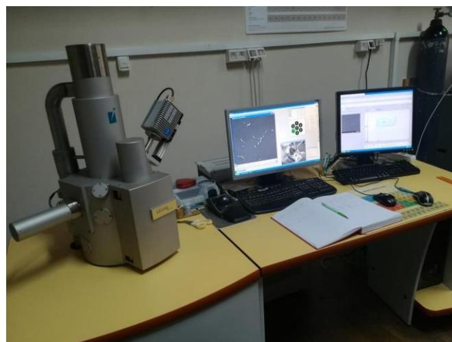
**Slika 21.** Skenirajući elektronski mikroskop (SEM)
