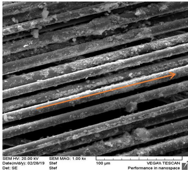
**Slika 26.** Područje provedene analize na  $\text{TiO}_2/\text{MWCNT}$  mrežici
