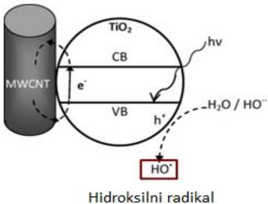
**Slika 11.** Pojednostavljeni prikaz interakcije između  $\text{TiO}_2$  i CNT i način na koji se  $\text{HO}^\bullet$  mogu formirati nakon generiranja  $e^- / h^+$  para [24]
