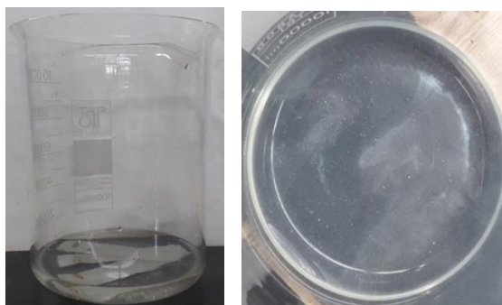
Slika 23. Otpadanje \text{TiO}_2 sloja u vodi tijekom starenja
