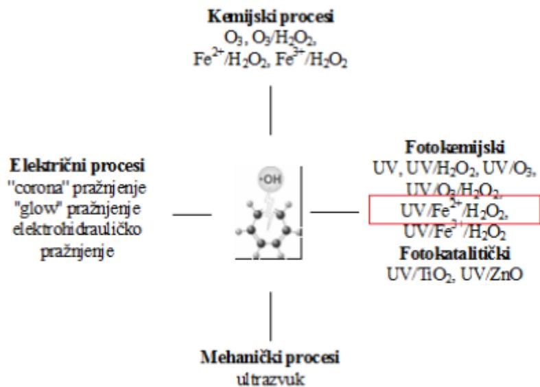
Slika 4. Shematski prikaz naprednih oksidacijskih procesa i njegovih kombinacija [9]
