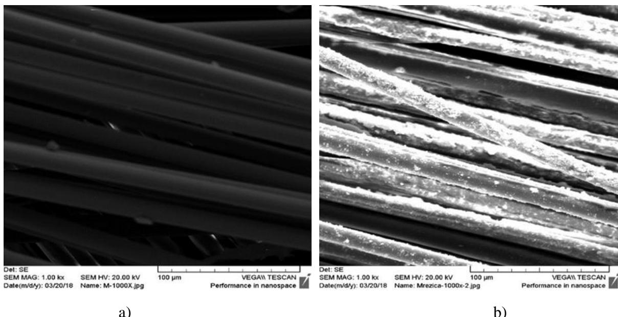
**Slika 25.** a) SEM čiste mrežice, b) SEM  $\text{TiO}_2$
