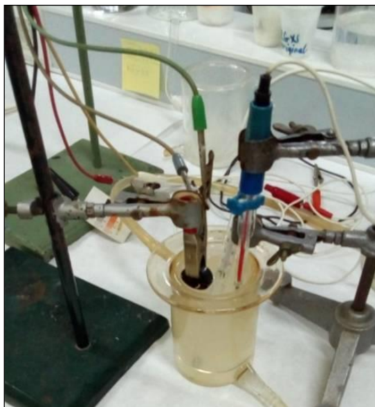
Slika 38. Troelektrodna staklena ćelija za elektrokemijska mjerenja
