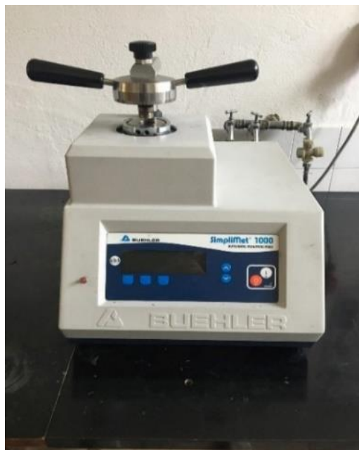
Slika 35. Uređaj SimpliMet 1000 za ulaganje uzoraka toplim prešanjem
