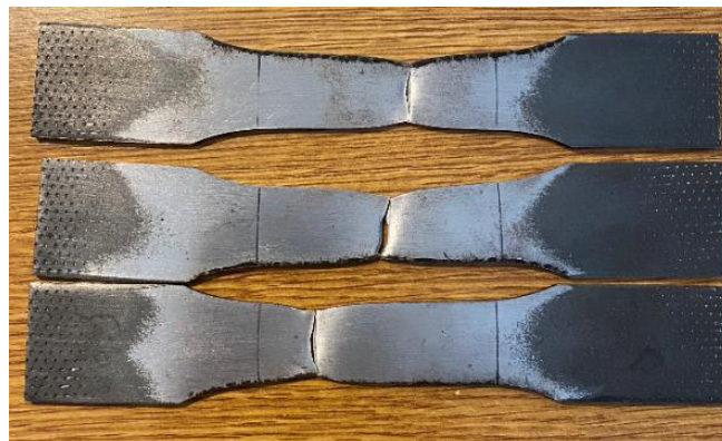
Slika 41. Uzorci nakon statičkog vlačnog ispitivanja kut 45^\circ
