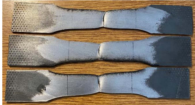
Slika 39. Uzorci nakon statičkog vlačnog ispitivanja kut 0^\circ
