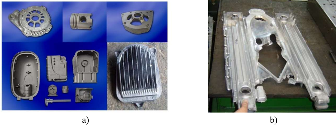
Slika 2. Odljevci proizvedeni visokotlačnim lijevom: a) razni dijelovi, b) radiator [5]
