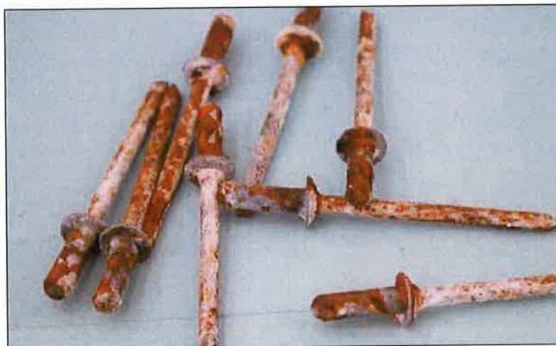
Slika 2. Kemijska korozija blok zakovica i zakivnih matica [6]
