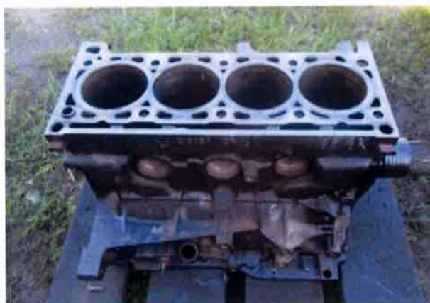
Slika 19. Blok motora očišćen mehaničkim i kemijskim putem
