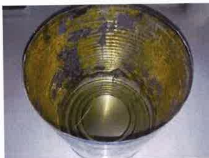
Slika 5. Elektrokemijska korozija limenke za pakiranje voćnog kompota [9]
