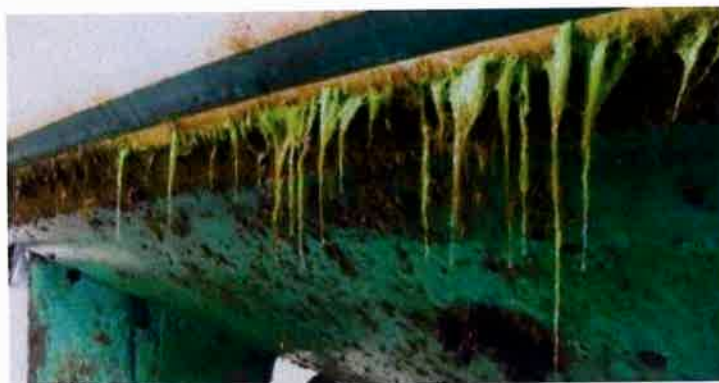
Slika 6. Biokorozija trupa broda [13]
