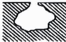
d) PODPOVRŠINSKA KOROZIJA
