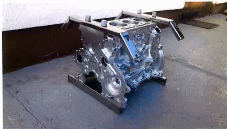
Slika 21. Blok motora zaštićen od korozije kromovom prevlakom
