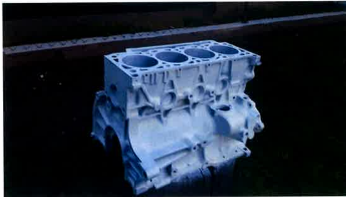
Slika 20. Blok motora zaštićen temeljnom bojom
