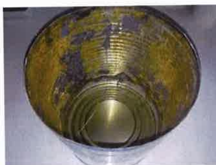
Slika 5. Elektrokemijska korozija limenke za pakiranje voćnog kompota [9]
