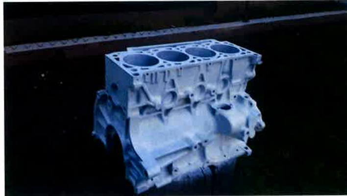
Slika 20. Blok motora zaštićen temeljnom bojom
