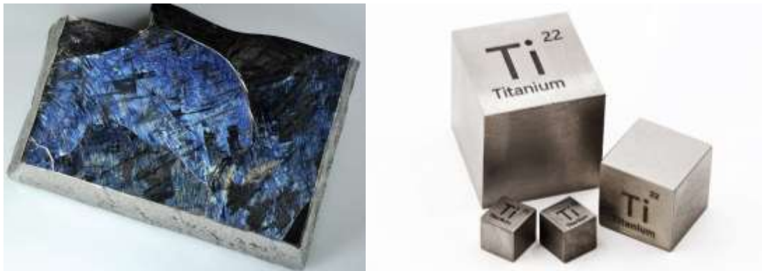
Slika 1. Metalni titan visoke čistoće (99,999 %) [4,5]
