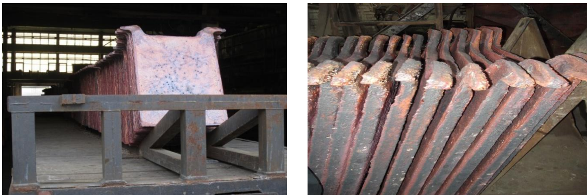
Slika 15. Svježe izliveni anodni bakar (TIR Bor)
