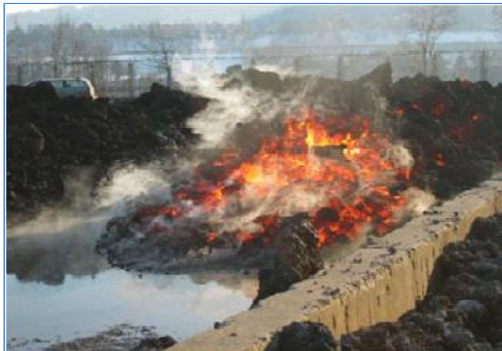
Slika 12. Brzo hlađenje troske vodom – u bazenima [27]
