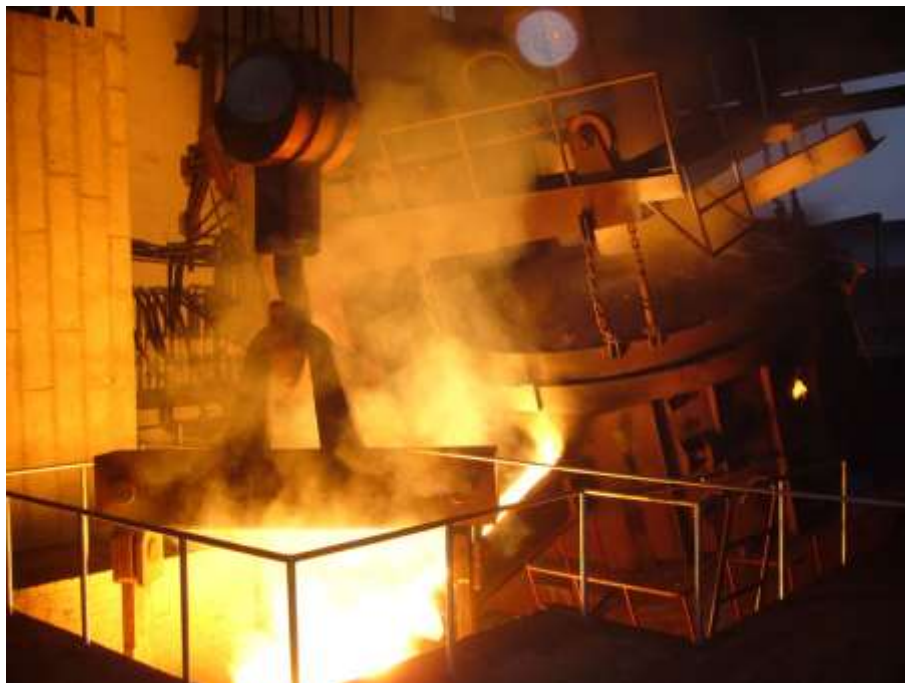
Slika 8. Izlijevanje čelika iz elektrolučne peći [28]
