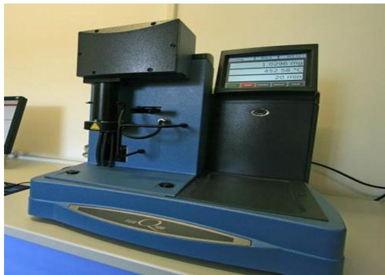
*Slika 7. Termogravimetar Q500, TA Instruments*
