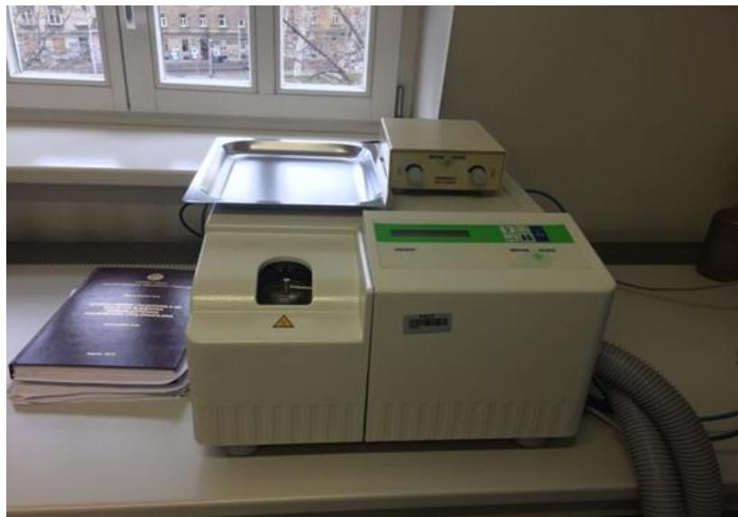
***Slika 6. Diferencijalni pretražni kalorimetar Mettler-Tolledo 822e***
