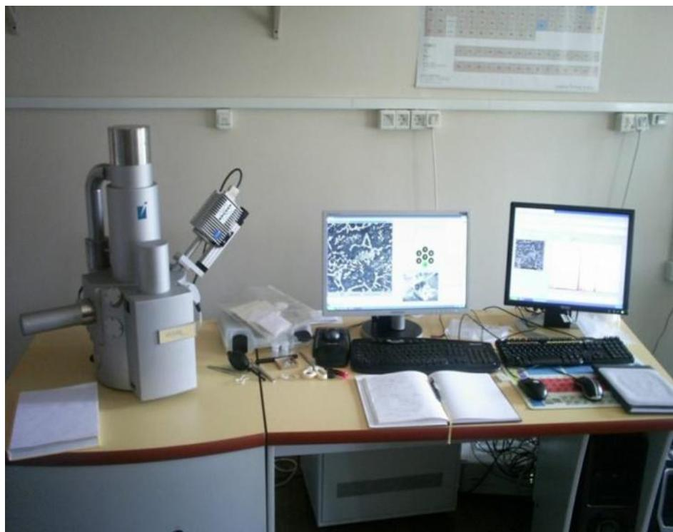
*Slika 8. Skenirajući elektronski mikroskop Tescan Vega TS 5136 MM*
