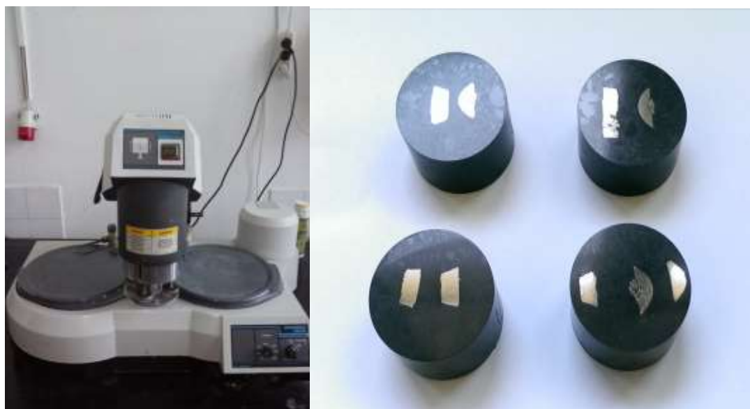
Slika 19. Uređaj za brušenje i poliranje (lijevo); polirani izbrusci (desno)
