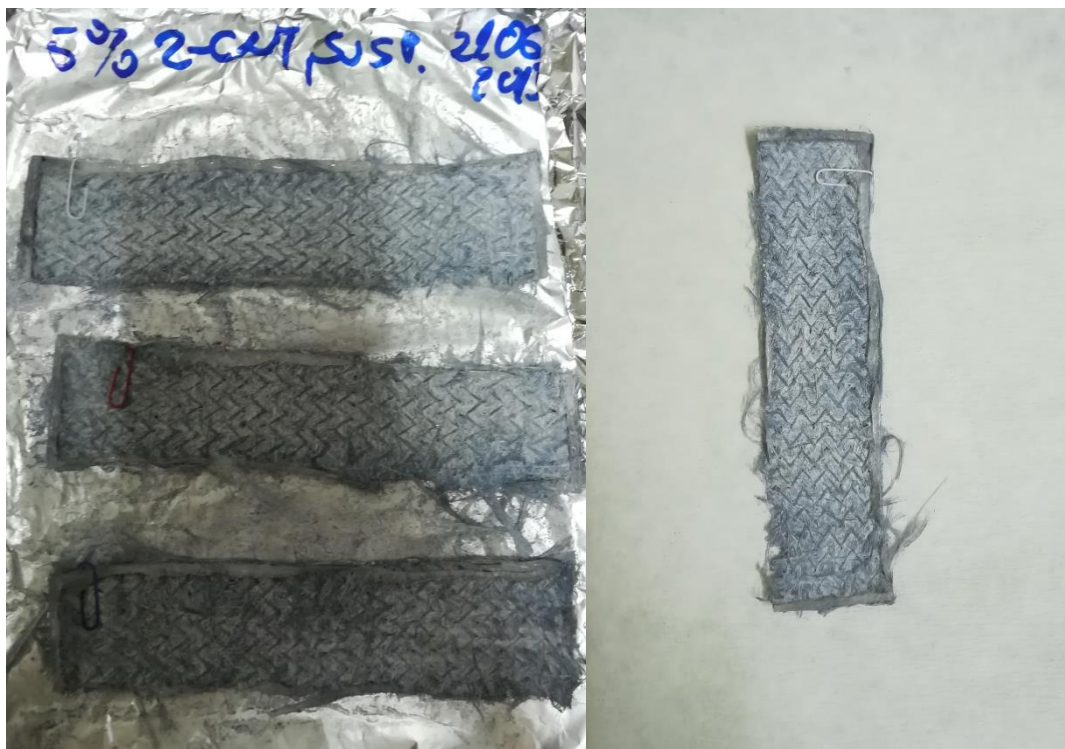
Slika 11. Prikaz mrežice sa 5 % ugljikovih nanocijevi.
