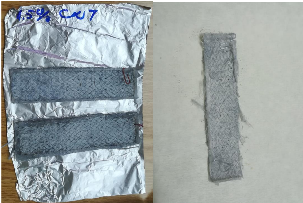
Slika 10. Prikaz mrežice sa 1,5 % ugljikovih nanocijevi.
