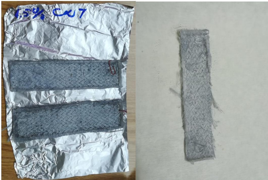
Slika 10. Prikaz mrežice sa 1,5 % ugljikovih nanocijevi.
