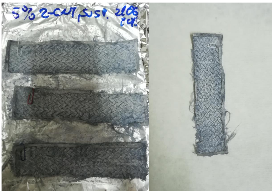
Slika 11. Prikaz mrežice sa 5 % ugljikovih nanocijevi.
