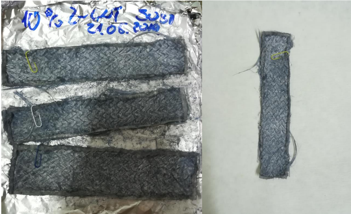
Slika 12. Prikaz mrežice sa 10 % ugljikovih nanocijevi.
