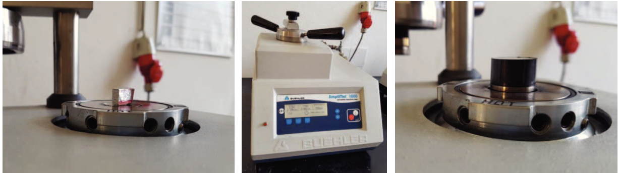
(a) (b) (c) Slika 46. Priprema uzorka vrućim ulaganjem: (a) postavljanje uzorka u komoru, (b) uređaj za vruće ulaganje, (c) uloženi uzorak
