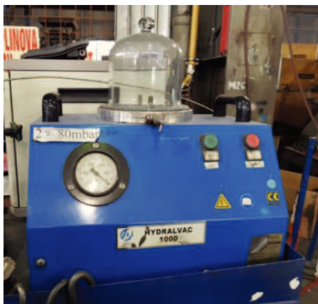
Slika 37. Uređaj za analizu indeksa gustoće
