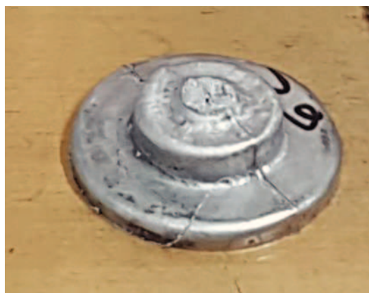
Slika 38. Uzorak za ispitivanje kemijskog sastava
