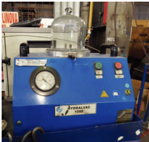
Slika 37. Uređaj za analizu indeksa gustoće
