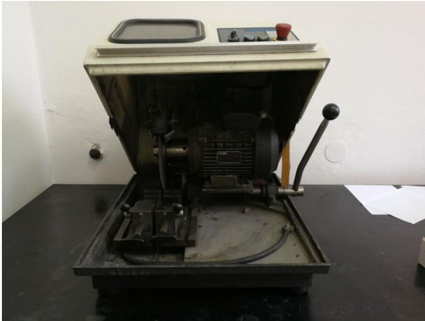
Slika 12. Fotografija rezalice Isomet proizvođača Buehler
