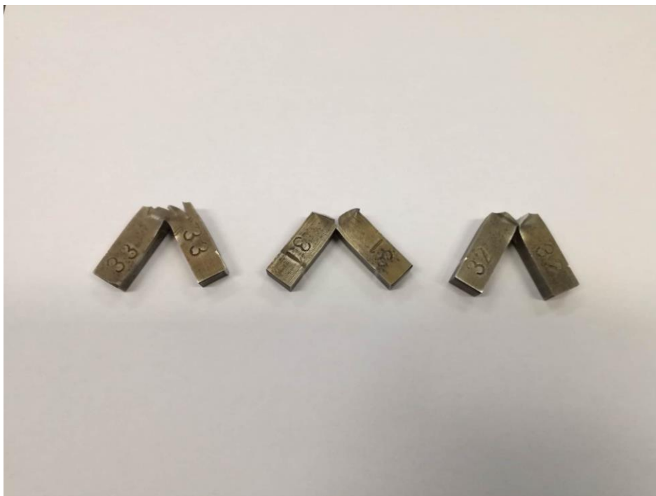
Slika 21. Fotografija uzoraka nakon mjerenja udarne radnje loma
