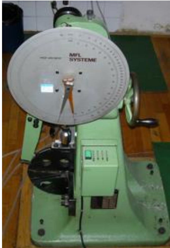
Slika 20. Fotografija uređaja za mjerenje udarne radnje loma po Charpyju
