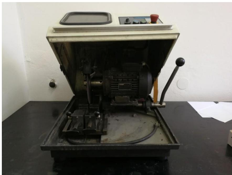
Slika 12. Fotografija rezalice Isomet proizvođača Buehler
