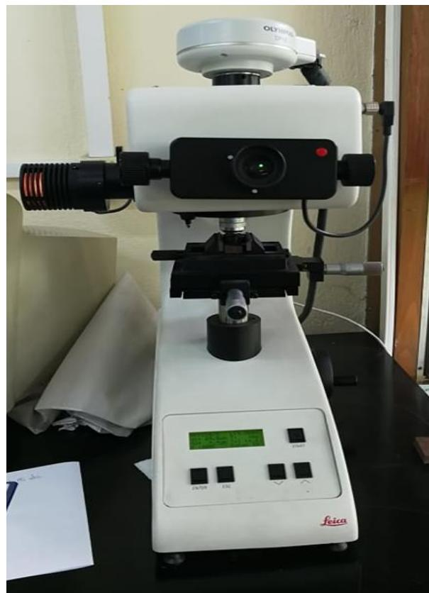
Slika 19. Fotografija mikrotvrdomjera Leica VHMT korištenog za ispitivanje mikrotvrdoće
