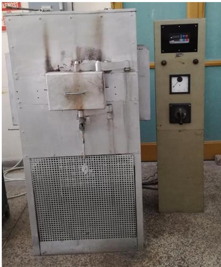
Slika 10. Fotografija elektrootporne komorne peći za žarenje
