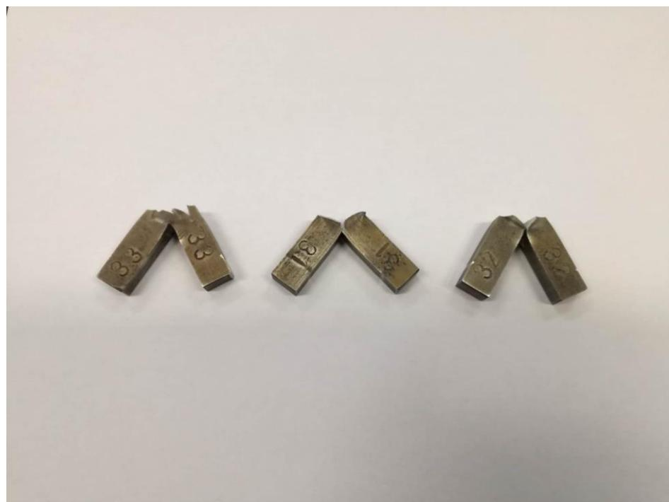
Slika 21. Fotografija uzorka nakon mjerena udarne radnje loma
