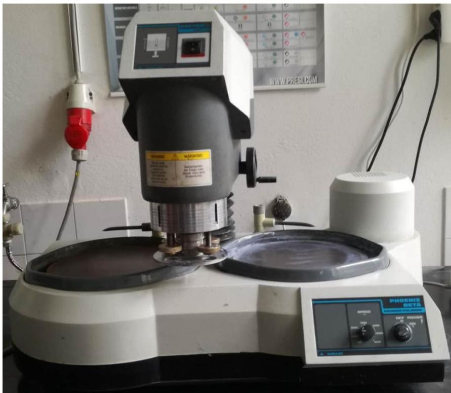
Slika 14. Fotografija uređaja Phoenix Beta proizvođača Buehler za brušenje i poliranje uzorka
