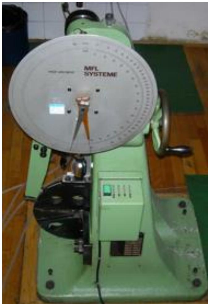
Slika 20. Fotografija uređaja za mjerjenje udarne radnje loma po Charpyju
