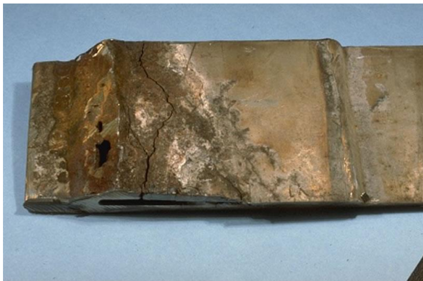
Slika 7. Pukotine uzrokovane napetosnom korozijom [17]
