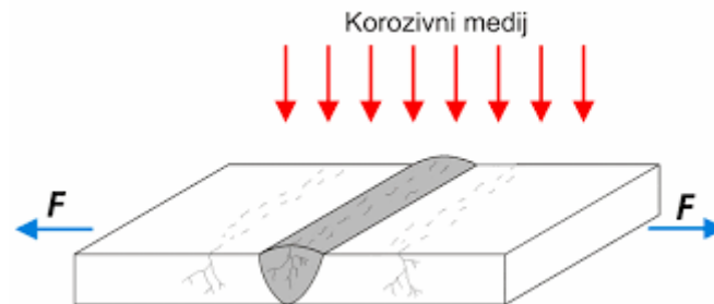
Slika 8. Čimbenici koji utječu na pojavu napetosne korozije [18]
