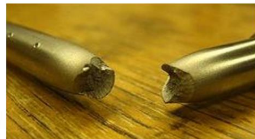
Slika 6. Prikaz (a) krhkog i (b) duktilnog loma [16]
