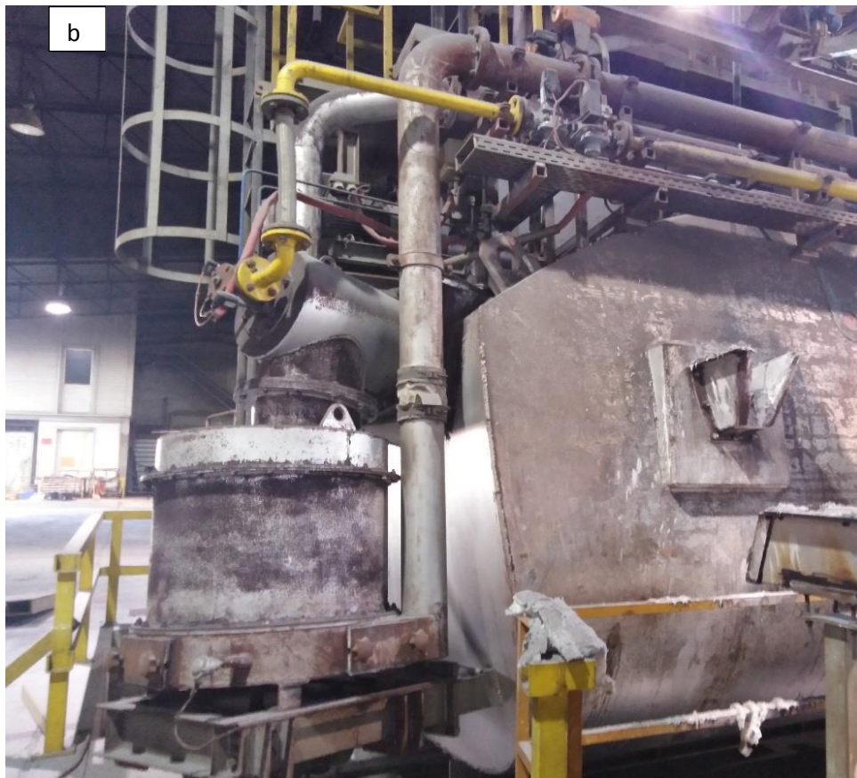
Slika 35. a) Sklopni crtež regenerativnog gorionika na peći za držanje taline b) regenerativni gorionik u CIAL d.o.o.
