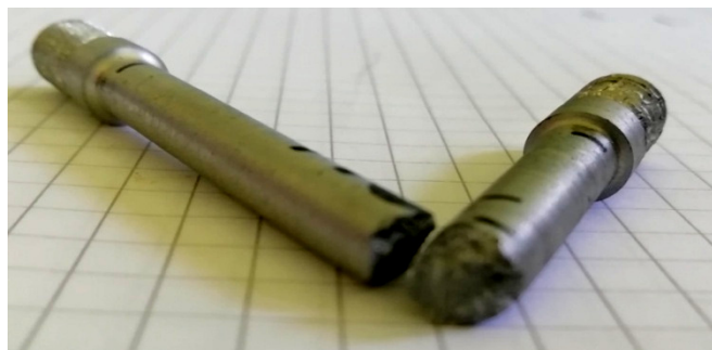
Slika 49. Uzorak za mehanička ispitivanja nakon kidanja
