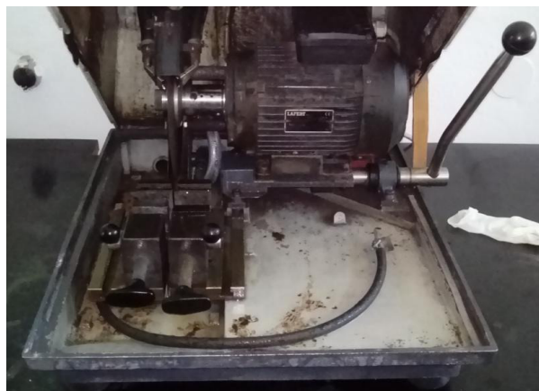
Slika 51. Rezalica sa sustavom za hlađenje emulzijom
