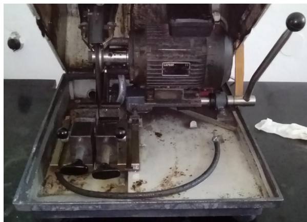
Slika 51. Rezalica sa sustavom za hlađenje emulzijom
