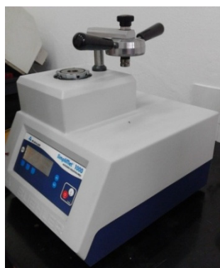
Slika 52. Uređaj za vruće ulaganje uzoraka SimpliMet 1000
