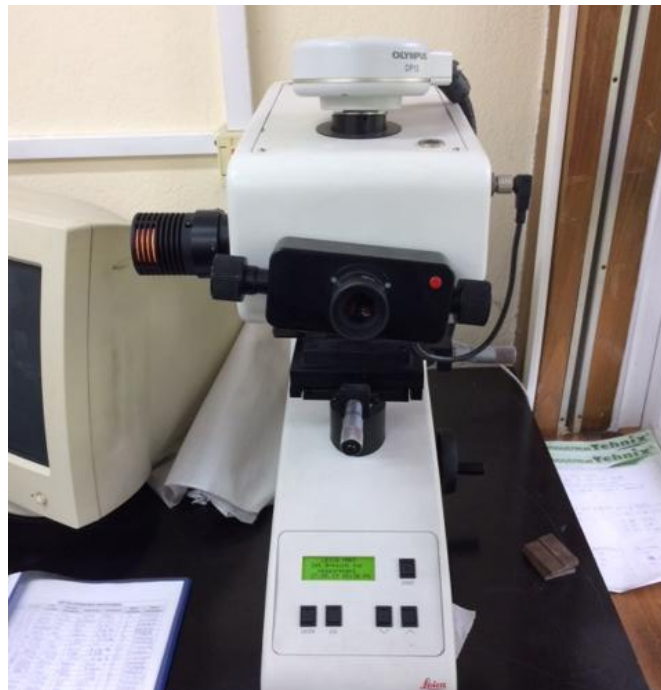
Slika 18. Fotografija tvrdomjera Leica VHMT
