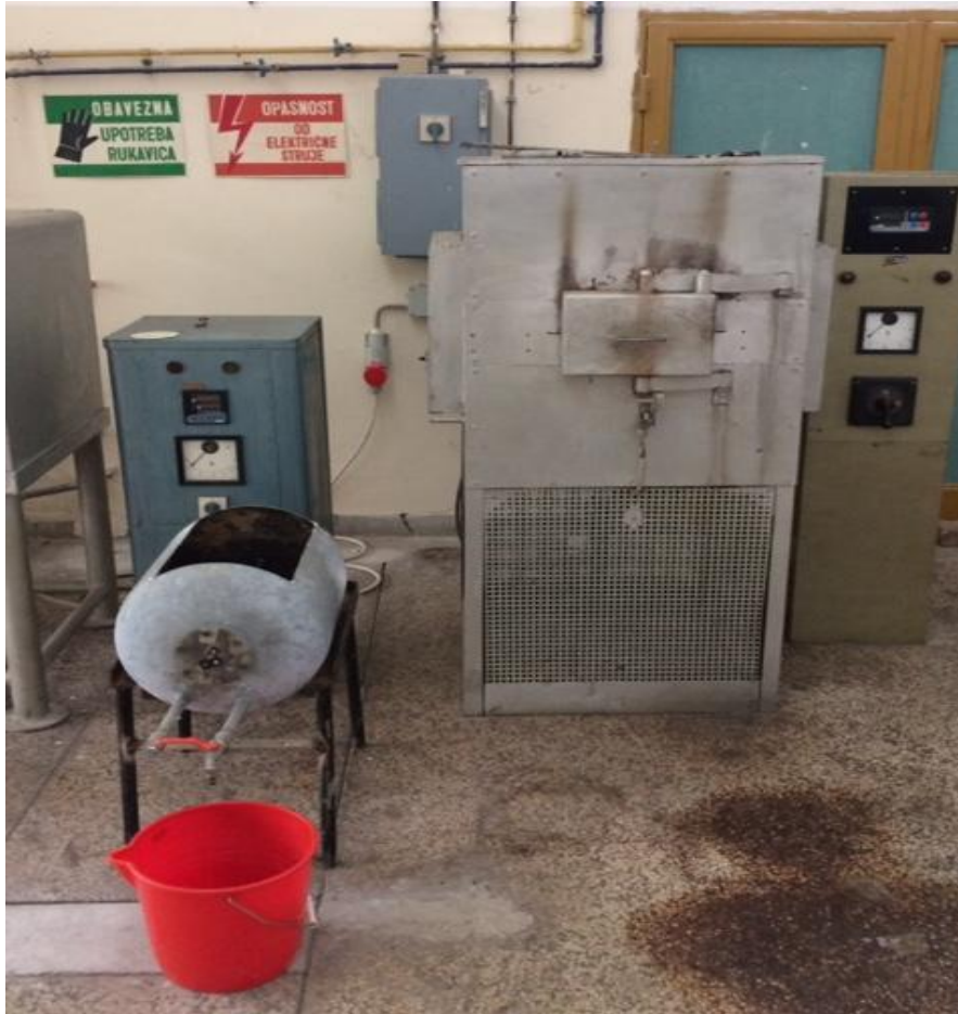
Slika 14. Fotografija peći za toplinsku obradu i posude za hlađenje uzoraka
