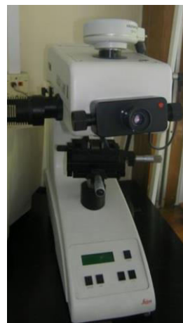
Slika 25. Mikro-tvrdomjer LEICA VMHT
