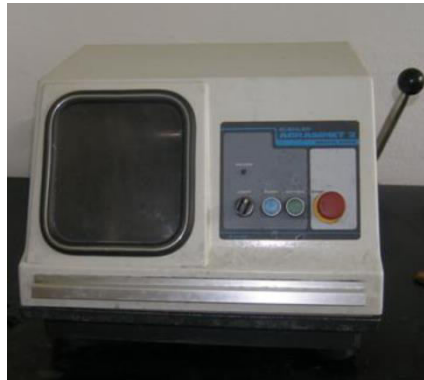
Slika 20. Rezalica Buehler ABRASIMET 2
