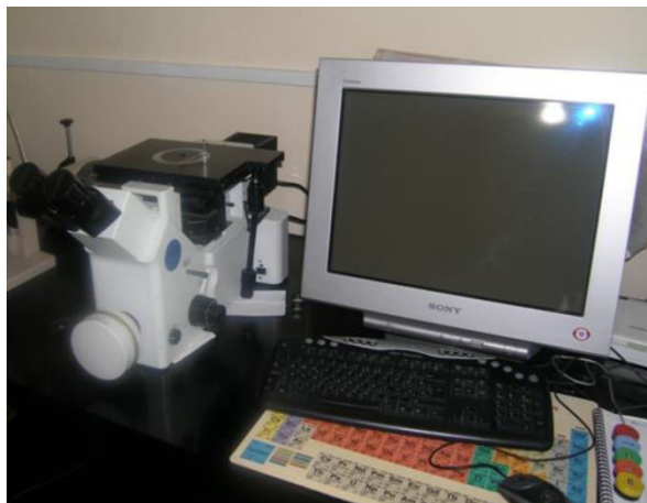
Slika 22. Invertni metalografski mikroskop Olympus GX 71
