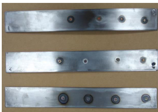
Slika 19. Zavareni uzorci iz limova
