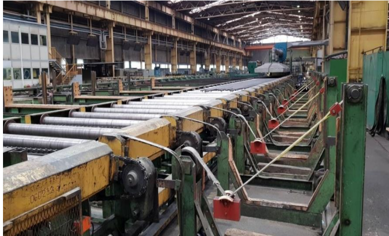
Slika 22. Cijevi nakon žarenja u peći
