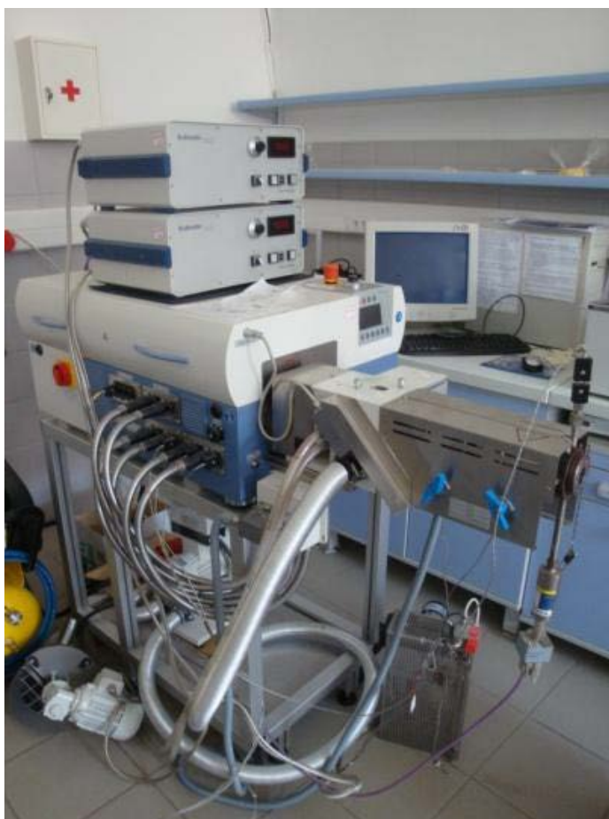
Slika 27. Laboratorijski jednopužni ekstruder Brabender 19/20 DN
