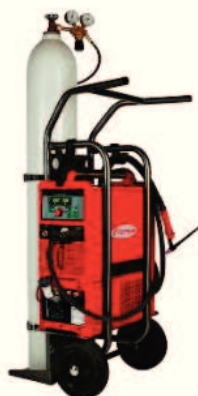
Slika 14. Aparat za zavarivanje "TransTig 2500" [22].
