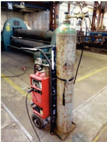
Slika 27. TransTig 2500 aparat za zavarivanje.
