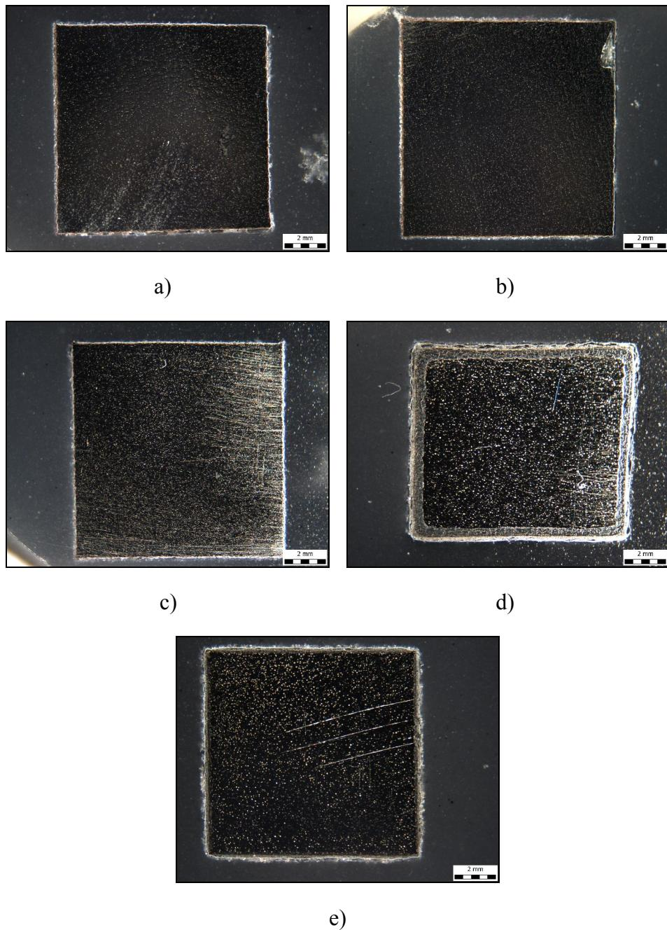
Slika 4.6. Snimke makrostrukture ispitivanih nodularnih ljevova nakon zagrijavanja na  $850^{\circ}\text{C}$  u trajanju od 32 h: a) SiMo-1, b) SiMo-2, c) SiMo-3, d) GJS-1, e) GJS-2
