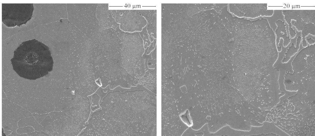
Slika 2.14. Snimke mikrostrukture SiMo nodularnog lijeva (4 mas. % Si, 1,4 mas. % Mo) pretražnim elektronskim mikroskopom. U feritnim zrnima mogu se uočiti fini sekundarni karbidi molibdена [26]
