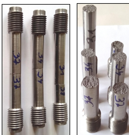
Slika 3.3. Ispitni uzorci nakon provedenog vlačnog ispitivanja
