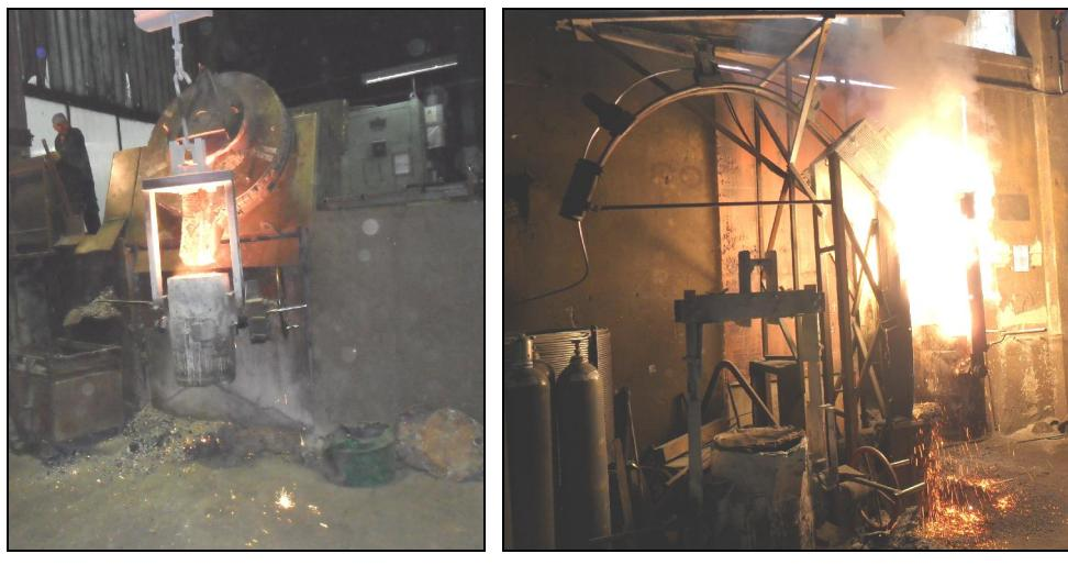
Slika 3.1. a) ispust primarne taline iz srednje-frekventne indukcionske peći u predgrijani lonac, b) nodulacija postupkom sa žicom punjenom s predlegurom FeSiMg
