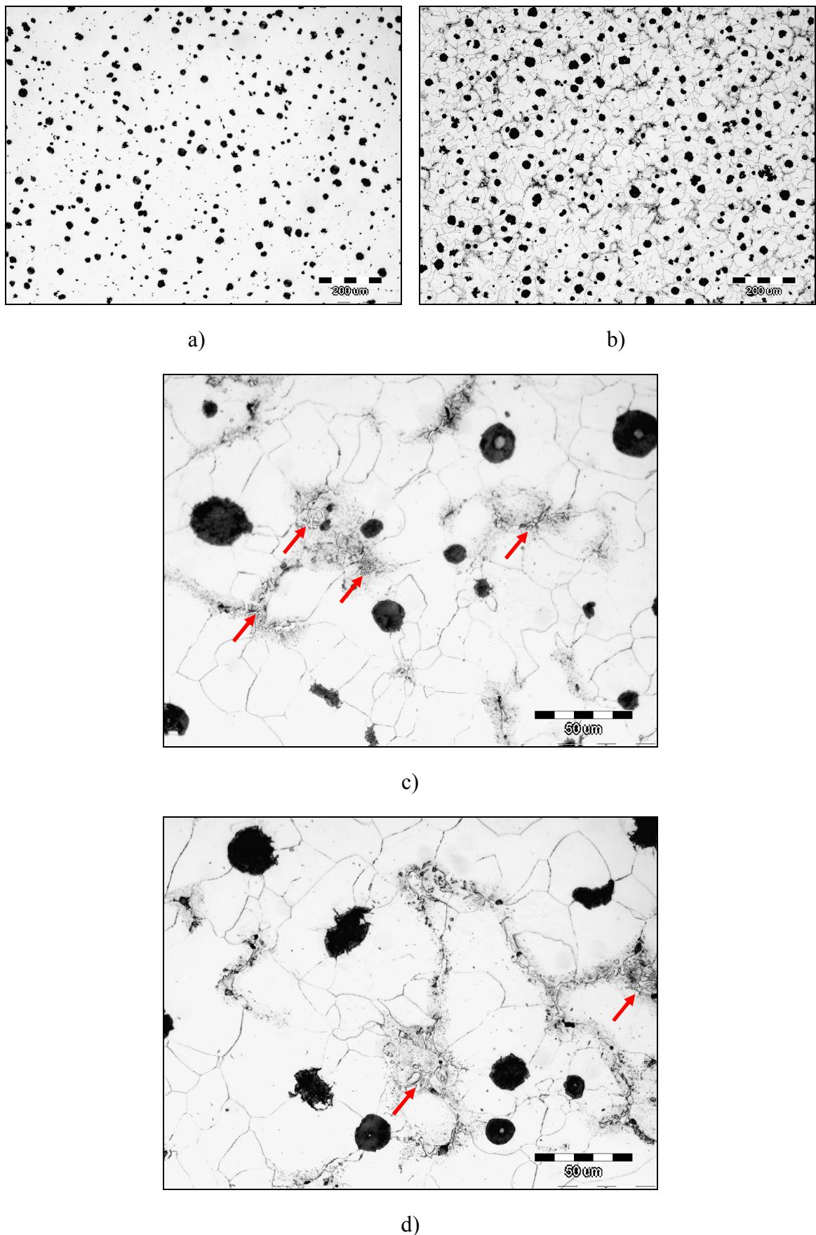
Slika 4.1. Metalografske snimke mikrostrukture SiMo-1: a) nenagrizeno stanje, b), c) i d) nagrizeno stanje, nital
