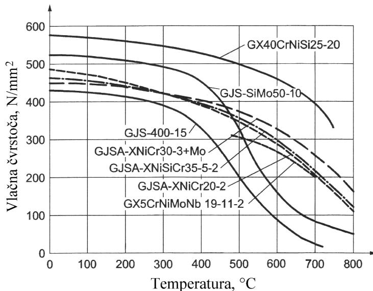
Slika 2.15. Utjecaj temperature na vlačnu čvrstoću feritnih i austenitnih nodularnih ljevova te dvije kvalitete legiranog čeličnog ljeva [7]
