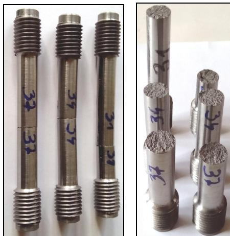
Slika 3.3. Ispitni uzorci nakon provedenog vlačnog ispitivanja
