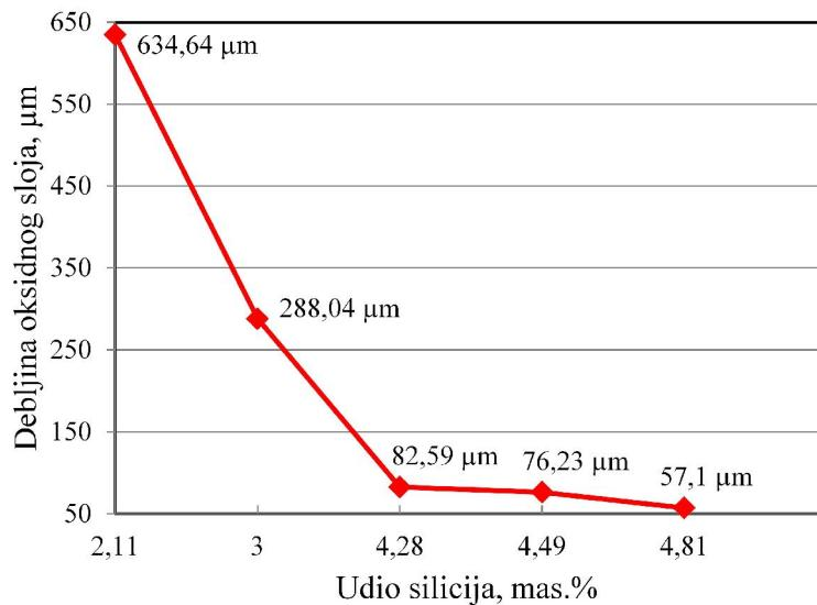
Slika 4.13. Utjecaj udjela silicija u ispitivanim nodularnim ljevovima na debljinu oksidnog sloja na površini uzorka nastalog tijekom zagrijavanja na 850 °C u trajanju od 32 h
