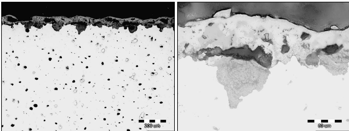
Slika 4.8. Metalografske snimke mikrostrukture površinskog dijela SiMo-1 nakon zagrijavanja na  $850^{\circ}\text{C}$  u trajanju od 32 h (nenagrizeno stanje)
