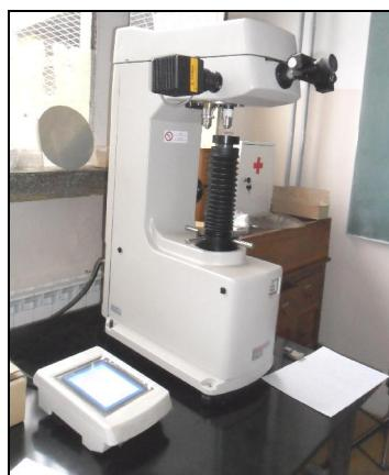
Slika 3.5. Ispitivanje tvrdoće metodom prema Vickersu
