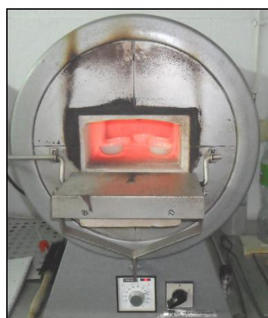
Slika 3.6. Zagrijavanje uzoraka u porculanskim zdjelicama u peći
