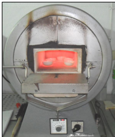
Slika 3.6. Zagrijavanje uzoraka u porculanskim zdjelicama u peći
