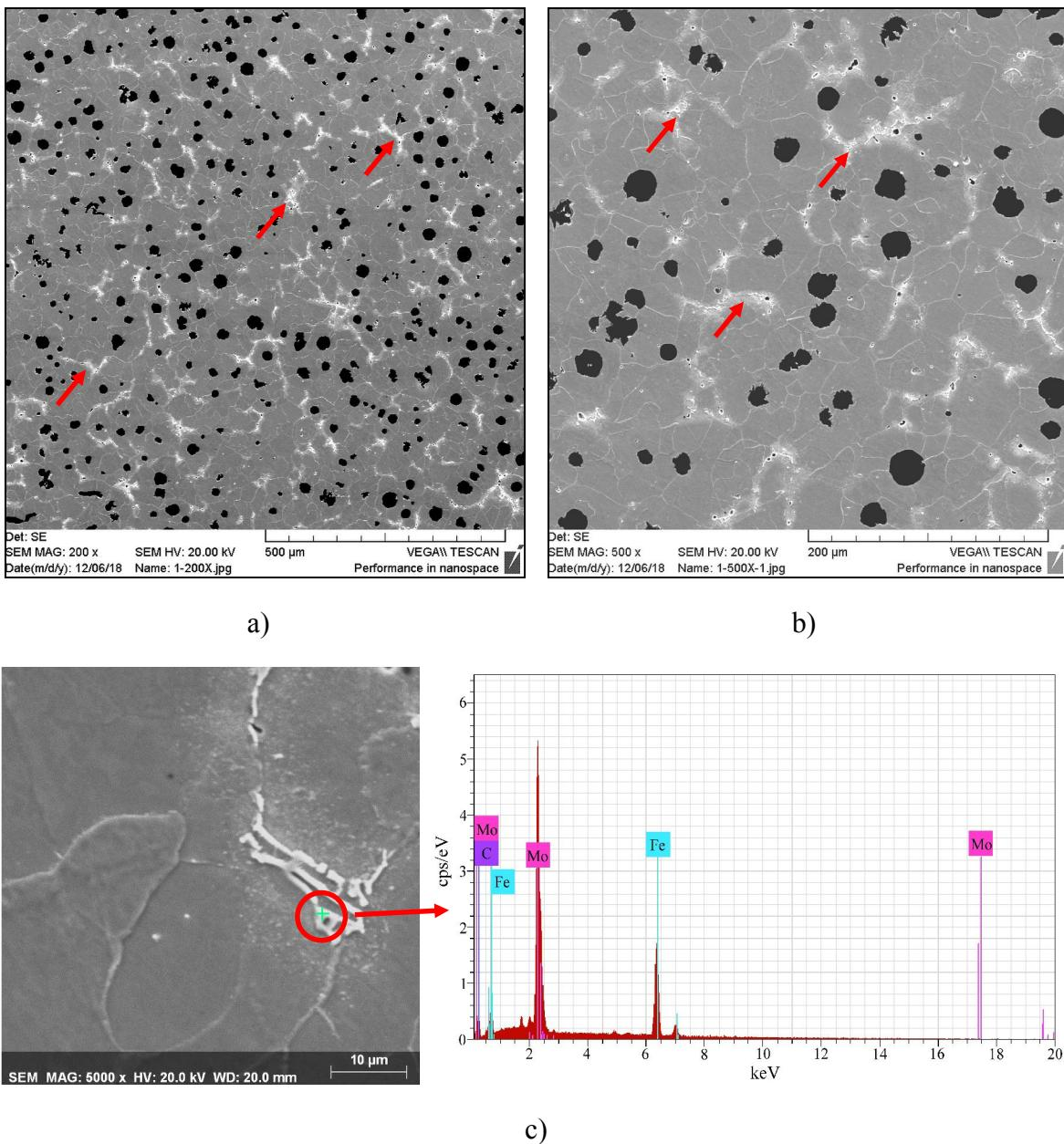
Slika 4.4. a) i b) snimke mikrostrukture SiMo-1 nodularnog lijeva dobivene pretraženim elektronskim mikroskopom (SEM), c) rezultati točkaste analize karbida u SiMo-1 nodularnom lijevu dobiveni pretražnim elektronskim mikroskopom s energijsko disperzijskim spektrometrom (SEM + EDS)
