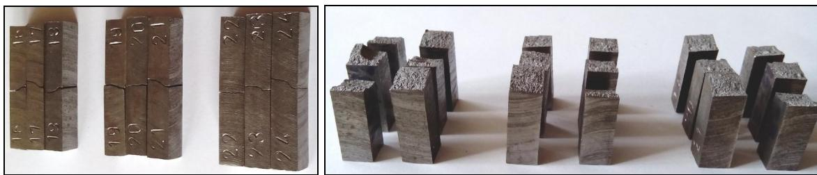
Slika 3.4. Ispitni uzorci nakon provedenog ispitivanja žilavosti
