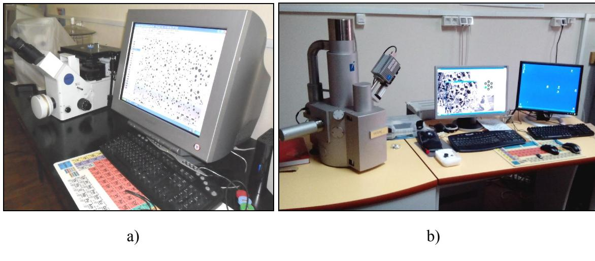
Slika 3.7. a) analiza uzorka na svjetlosnom metalografskom mikroskopu OLYMPUS GX 51 koji je opremljen digitalnom kamerom i programskim paketom AnalySIS® Materials Research Lab za obradu slike, b) analiza uzorka na pretražnom elektronskom mikroskopu TESCAN VEGA 5136MM koji je opremljen energijsko disperzijskim spektrometrom
