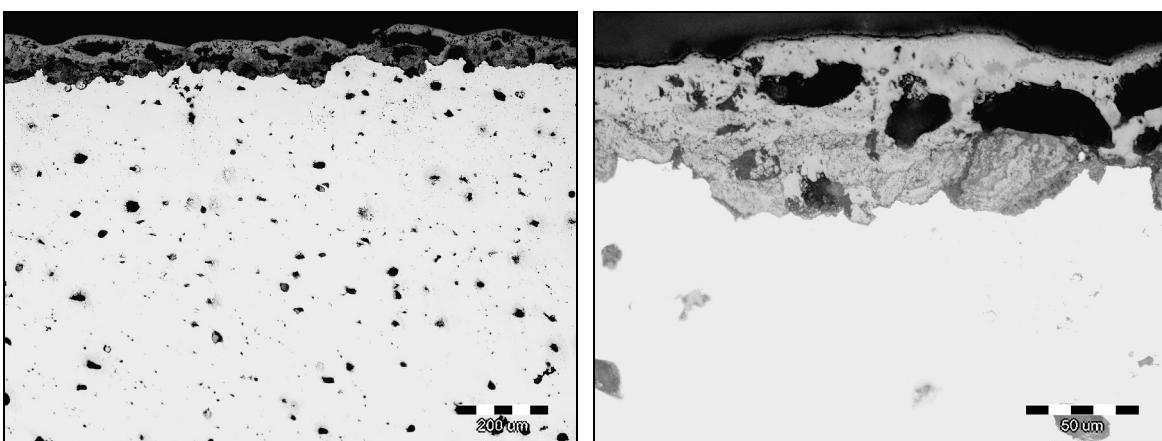
Slika 4.9. Metalografske snimke mikrostrukture površinskog dijela SiMo-2 nakon zagrijavanja na  $850^{\circ}\text{C}$  u trajanju od 32 h (nenagrizeno stanje)
