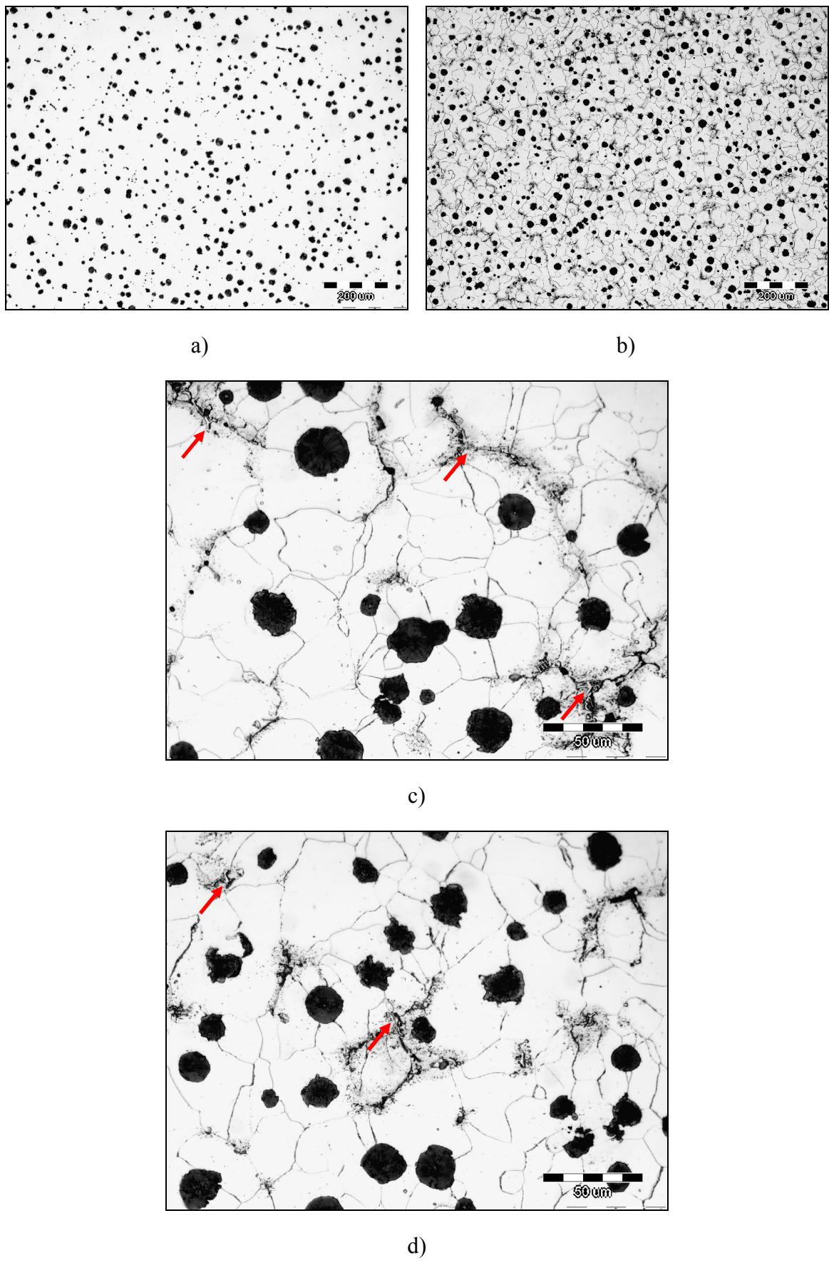
Slika 4.2. Metalografske snimke mikrostrukture SiMo-2: a) nenagrizeno stanje, b), c) i d) nagrizeno stanje, nital
