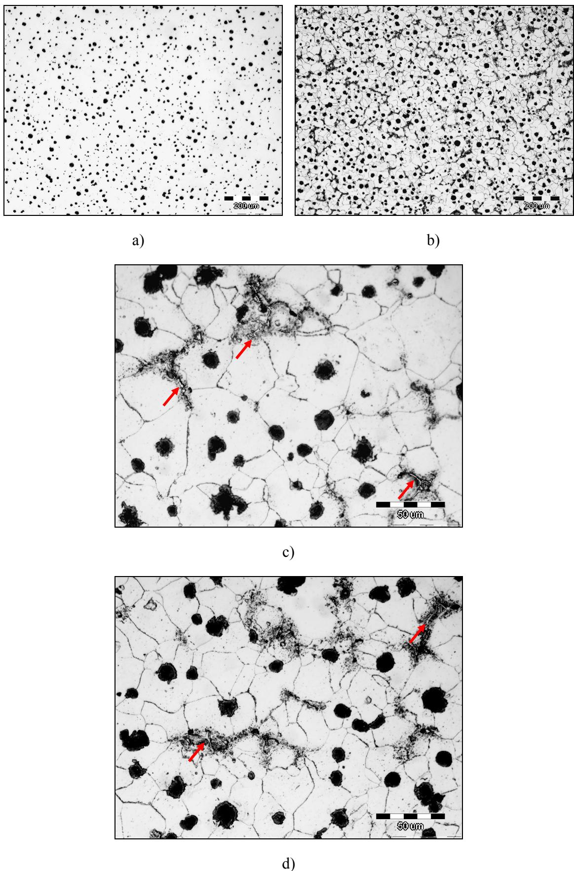
Slika 4.3. Metalografske snimke mikrostrukture SiMo-3: a) nenagrizeno stanje, b), c) i d) nagrizeno stanje, nital
