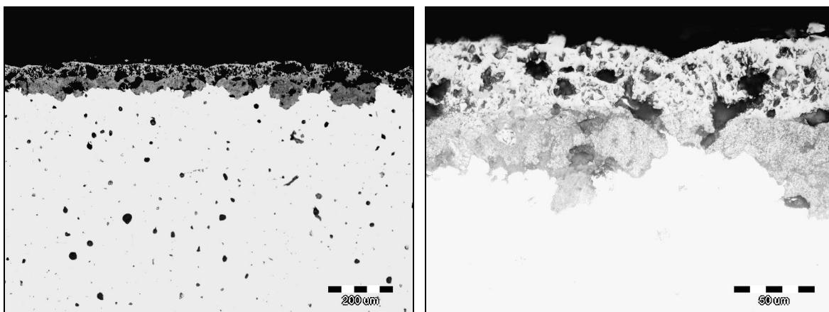
Slika 4.10. Metalografske snimke mikrostrukture površinskog dijela SiMo-3 nakon zagrijavanja na  $850^{\circ}\text{C}$  u trajanju od 32 h (nenagrizeno stanje)
