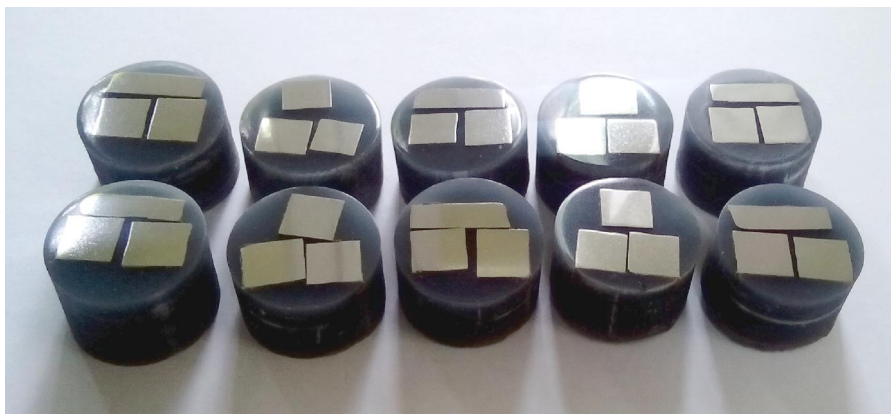
Slika 3.6. Pripremljeni uzorci za metalografsku analizu
