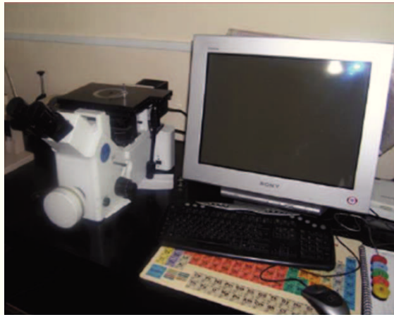
Slika 21. Invertni metalografski mikroskop Olympus GX 51 s digitalnom kamerom DP 70
