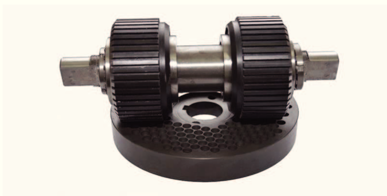
Slika 3. Matrica s valjcima za rolanje i osovinama [5]
