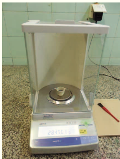
Slika 17. Vaganje porculanskog lončića s uzorkom na digitalnoj vagi
