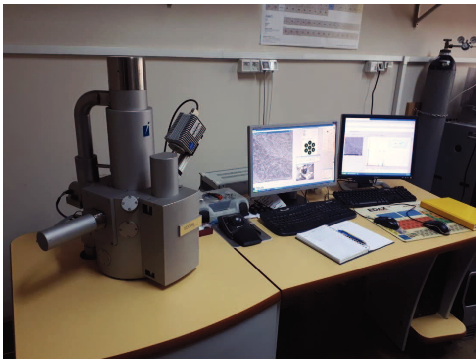
Slika 38. Fotografija pretražnog elektronskog mikroskopa Tescan VEGA 5136 MM
