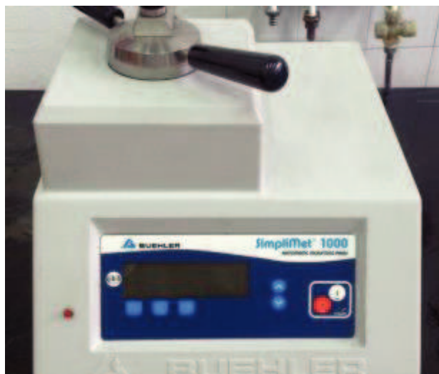
Slika 35. Fotografija uređaja Buehler Simplimet 1000 za vruće prešanje uzoraka u vodljivu masu
