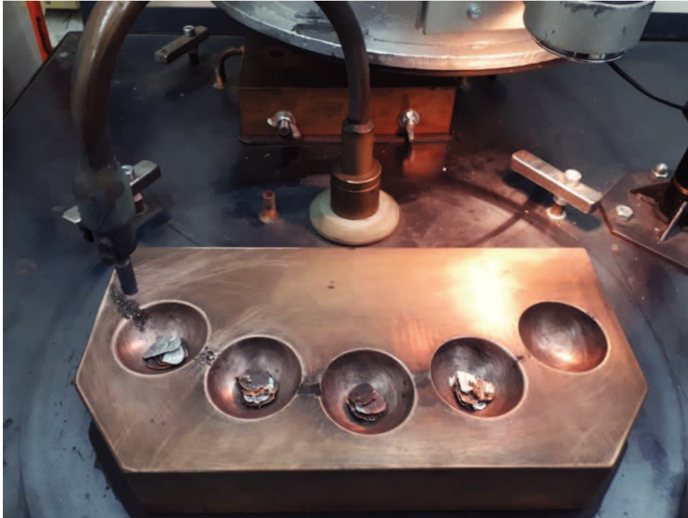
Slika 28. Fotografija bakrenog kalupa prije taljenja s postavljenim čistim metalima za dobivanje Cu-Al-Mn-Zn legure
