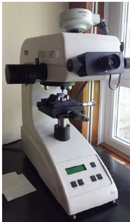
Slika 30. Mikrotvrdomer Leica VMHT.
