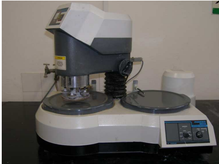
Slika 29. Uređaj za brušenje i poliranje uzoraka.
