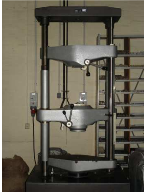
Slika 31. Kidalica WEB WPM/ EUmod/400 kN.
