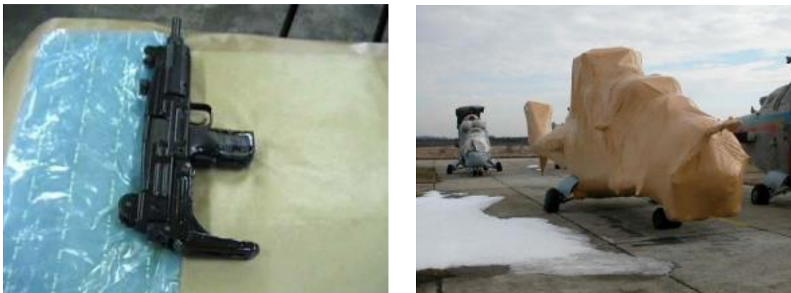
Slika 13. Praktična primjena hlapljivog inhibitora za zaštitu pješačkog naoružanja i borbenih letjelica [8]
