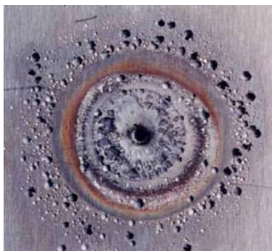
Slika 7. Primjer točkaste korozije u području pobojenosti zavarenog spoja [16]
