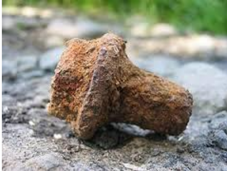
Slika 4. Praktični primjer elektrokemijske korozije čelika [12]
