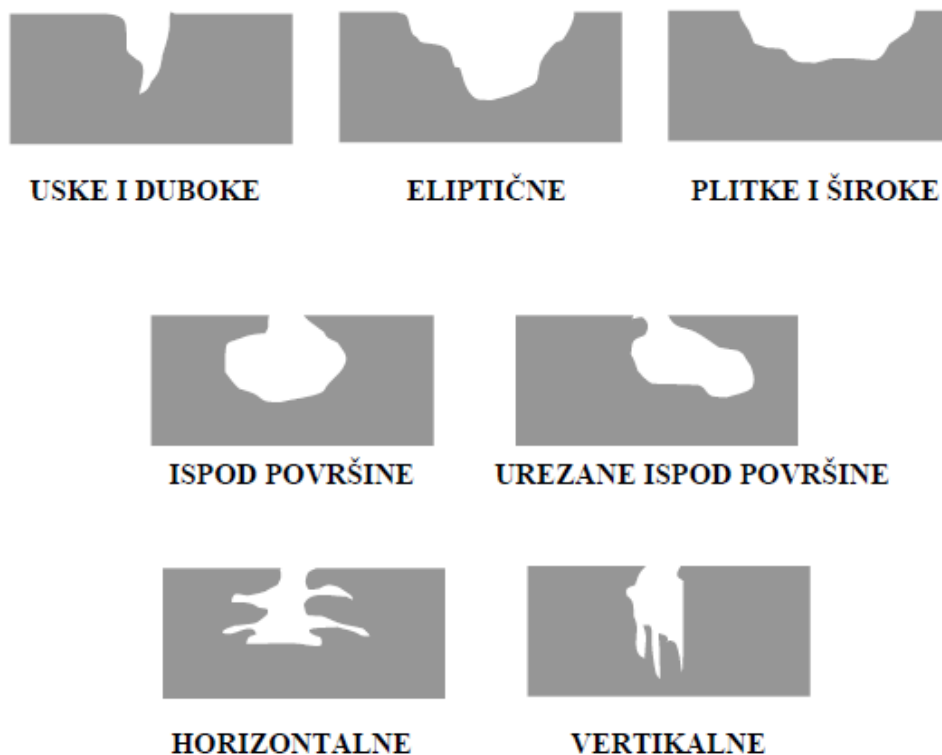
Slika 6. Oblici korozijskih oštećenja jamičaste korozije [15]
