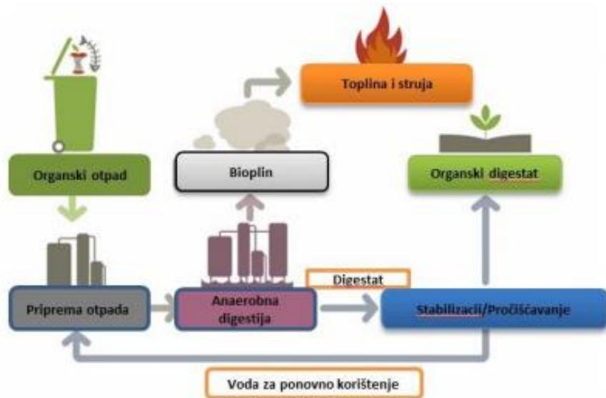
Slika 6. Shema anaerobne digestije [22]
