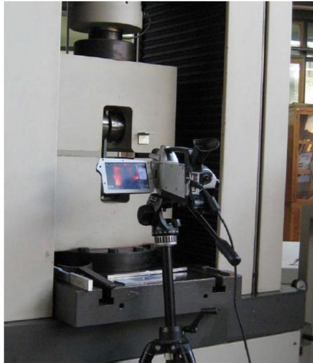
Slika 9. Ispitivanje metodom termografije [18]
