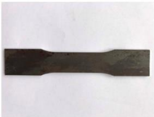
Slika 13. Uzorak za statičko vlačno ispitivanje prije brušenja
