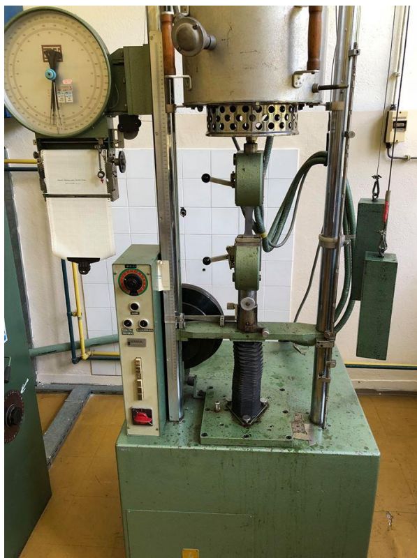
Slika 12. Kidalica Zwick 50 kN na kojoj je provedeno statičko vlačno ispitivanje na Metalurškom fakultetu
