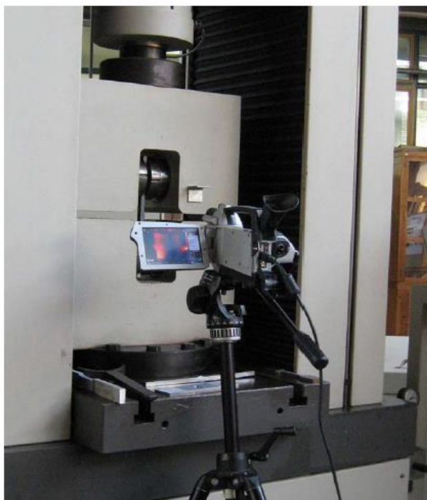
Slika 9. Ispitivanje metodom termografije [18]
