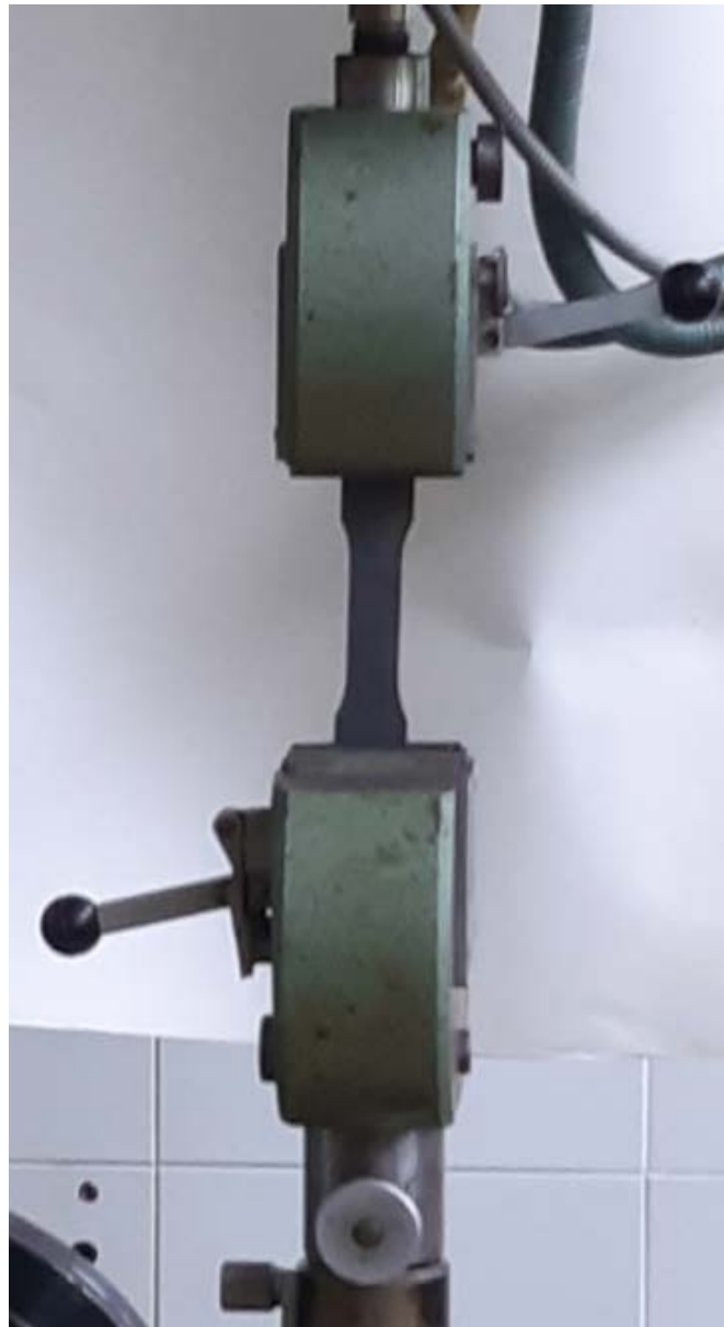
Slika 11. Čeljusti kidalice s postavljenim ispitnim uzorkom prije početka ispitivanja.
