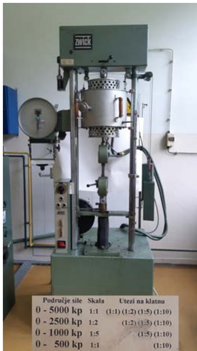
Slika 10. Kidalica Zwick 50 kN i mjerna područja.
