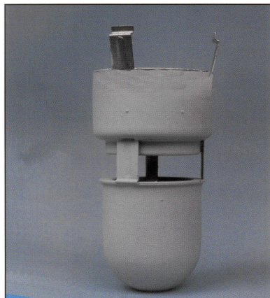
Slika 24. SinterCast ® proba za toplinsku analizu taline vermikularnog lijeva [19]
