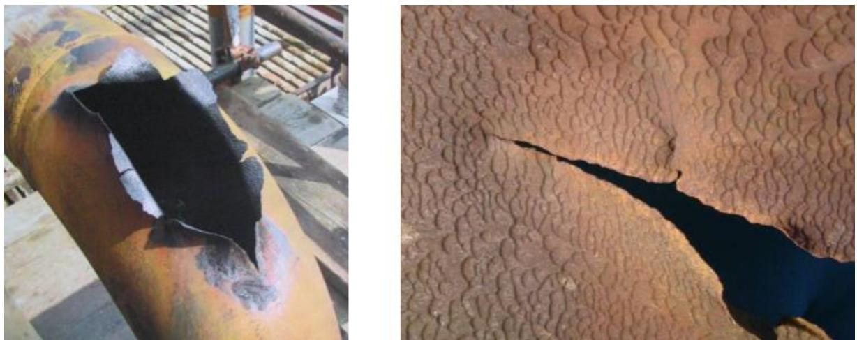
Slika 7. Posljedica erozijsko koroziskog oštećenja cjevovoda za transport nafte [14]
