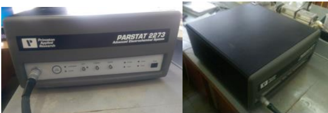
Slika 22. Mjerni uređaj za voltametrijska ispitivanja, potenciostat/galvanostat „Parstat 2273“
