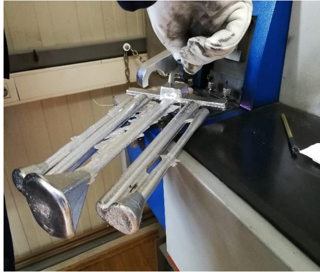
Slika 46. Odljevak iz ASTM kalupa
