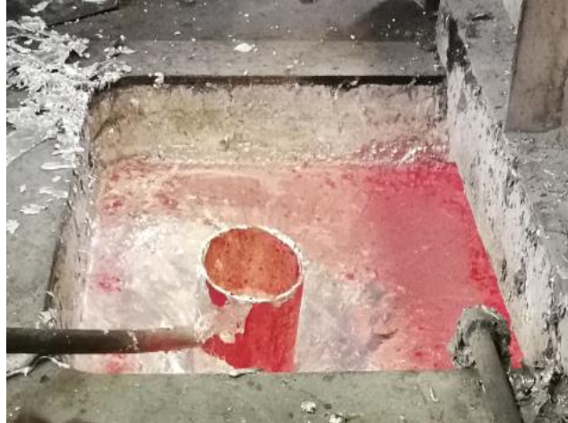
Slika 40. Lonac za talinu spojen s peći
