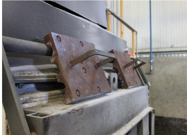
Slika 42. Predgrijavanje ASTM kokile na vratima peći
