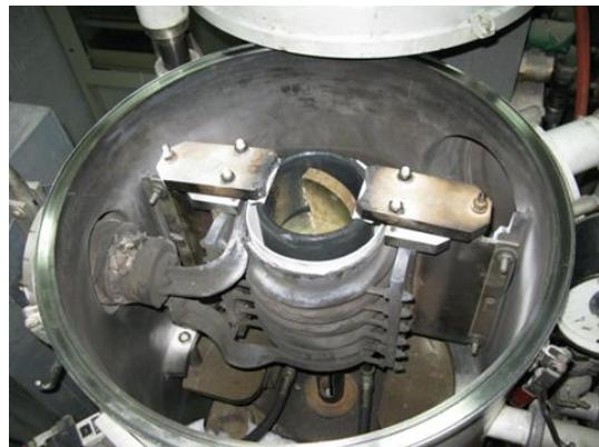
*Slika 27.* Vakuumska induksijska peć sa zaštitnom atmosferom argona
