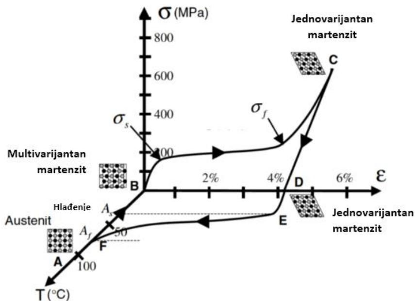
*Slika 15.* Naprezanje-deformacija-temperatura dijagram za Ni-Ti leguru [15]
