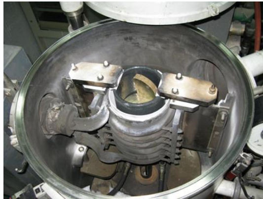
Slika 27. Vakuumska indukcijska peć sa zaštitnom atmosferom argona
