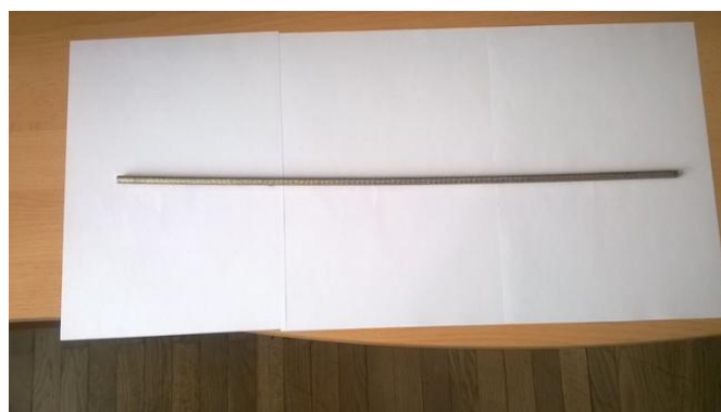
Slika 29. Dobivena šipka Cu-Al-Mn legure
