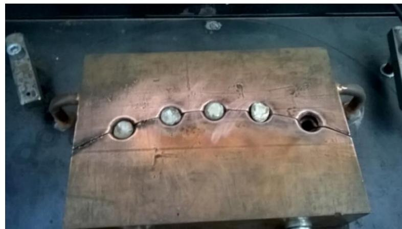
**Slika 25.** Kalup za lijevanje cilindričnih uzoraka
