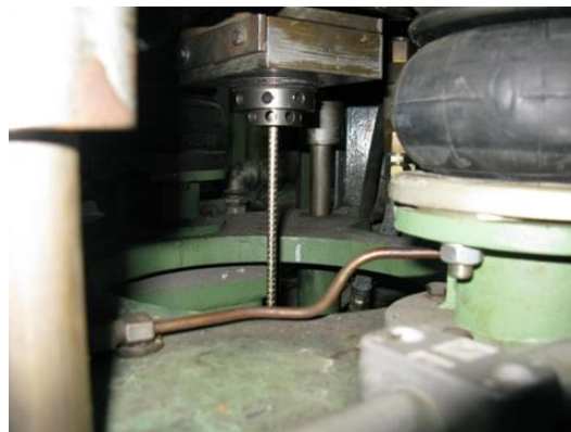
Slika 28. Fotografija izvlačenja šipke legure pri kontinuiranom lijevanju
