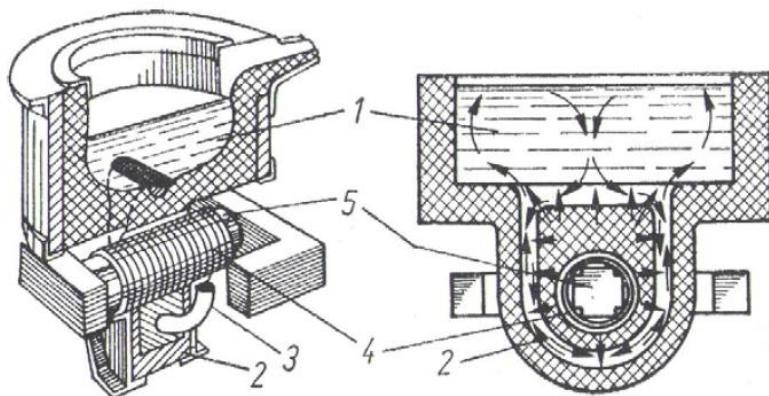
**Slika 8.** Prikaz induksijske peći: 1 metal,2 obloga,3 kanal,4 svitak,5 jezgra [10]
