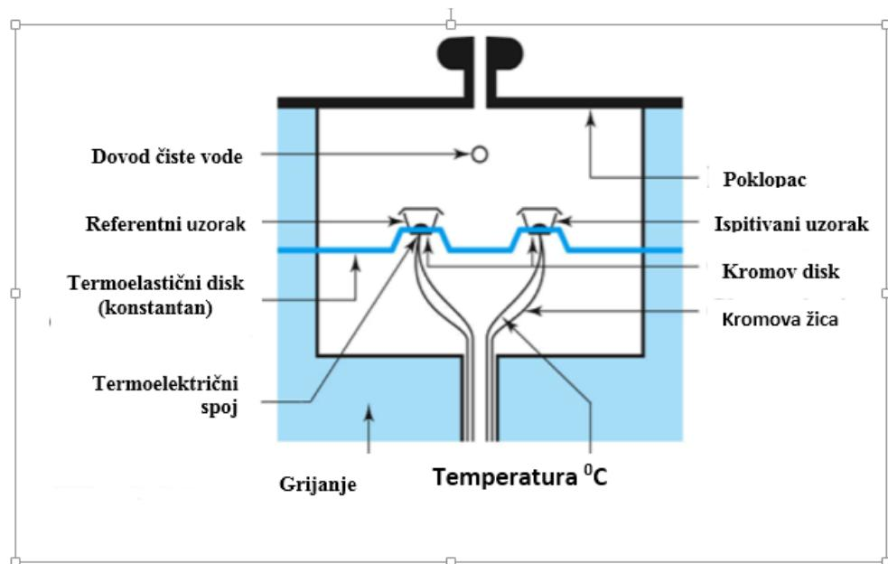
*Slika 19.* Shematski prikaz DSC uređaja s toplinskim tokom
