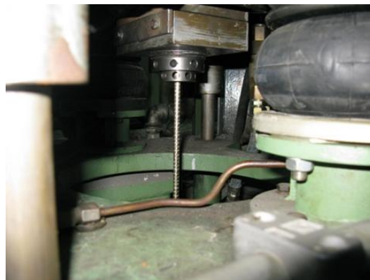
Slika 28. Fotografija izvlačenja šipke legure pri kontinuiranom lijevanju
