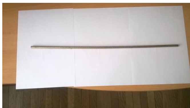
Slika 29. Dobivena šipka Cu-Al-Mn legure
