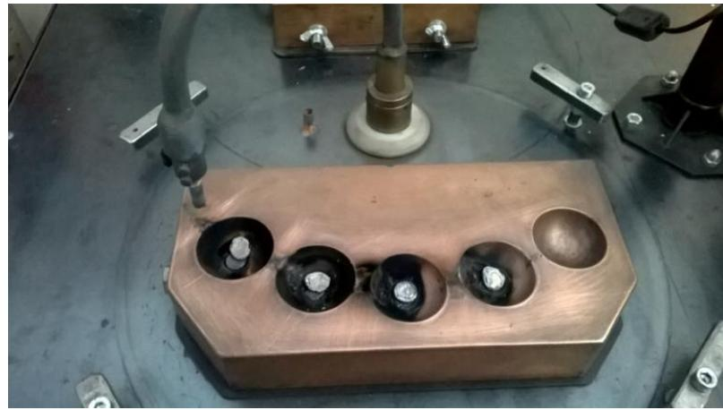
**Slika 24.** Fotografija uzorka Cu-Al-Mn legure nakon pretaljivanja
