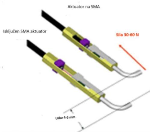
*Slika 3.* Primjena SMA legura u izradi aktuatora
