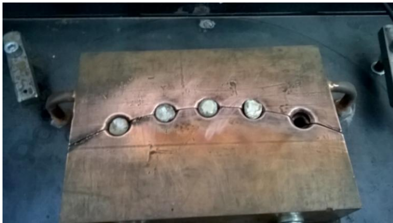
Slika 25. Kalup za lijevanje cilindričnih uzoraka
