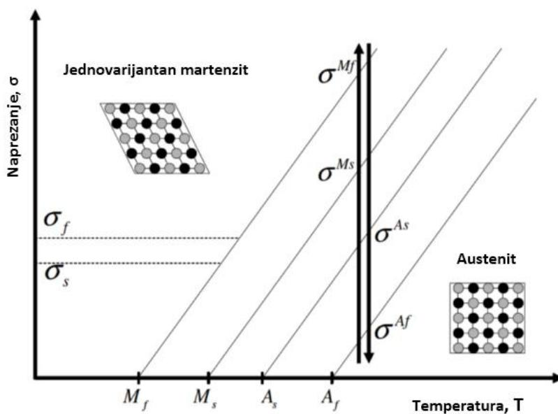
Slika 16. Prikaz efekta pseudoelastičnosti SMA legura
