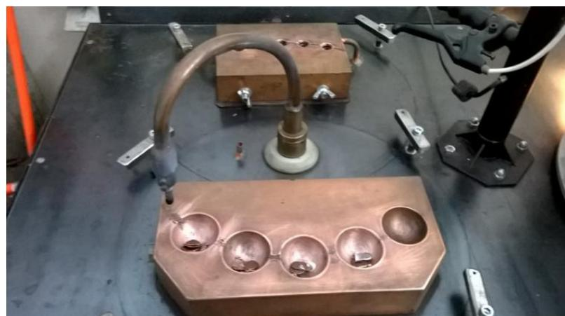
*Slika 23.* Odvagani čisti metali u bakrenom kalupu i grafitna elektroda
