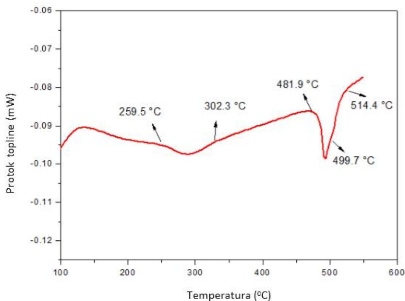
**Slika 36.** DSC krivulja zagrijavanja kontinuirano lijevane Cu-Al-Mn legure u lijevanom stanju
