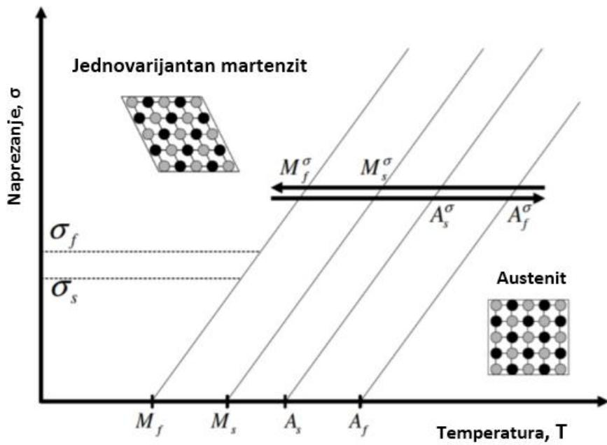
*Slika 14.* Temperaturno inducirana transformacija uz djelovanje naprezanja
