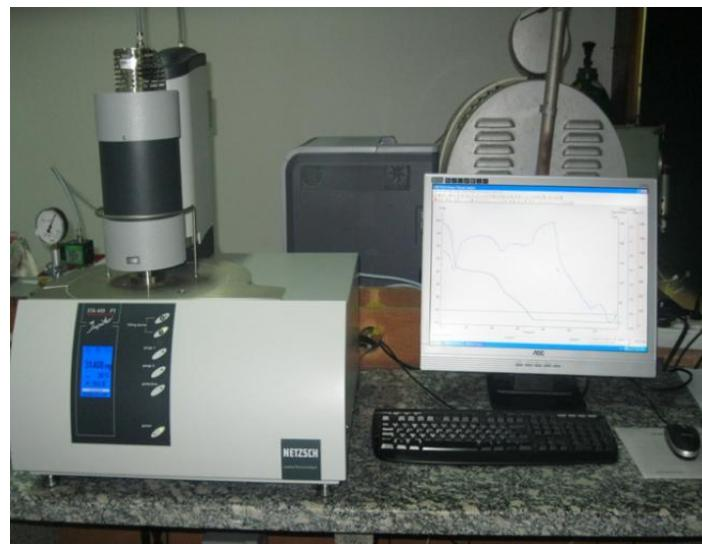
**Slika 34.** Uredaj za simultanu toplinsku analizu, STA DSC/TG NETZSCH
