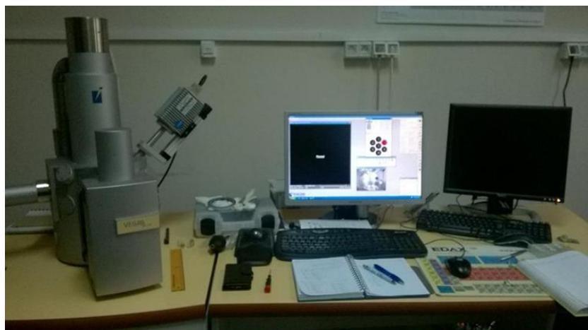
*Slika 33.* Skenirajući elektronski mikroskop TESCAN VEGA 5136 MM
