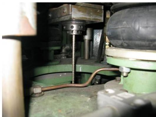
*Slika 28.* Fotografija izvlačenja šipke legure pri kontinuiranom lijevanju
