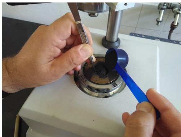
Slika 17. Postavljanje lima prije prešanja u masu
