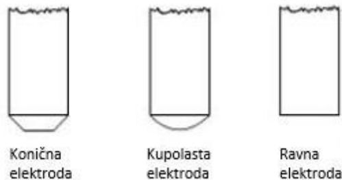
Slika 8. Najčešći oblici vrhova elektroda [15]
