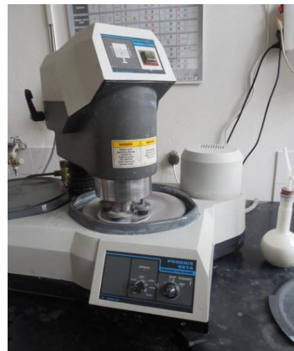
Slika 19. Uređaj za brušenje i poliranje uzoraka zalivenih u masu tijekom rada
