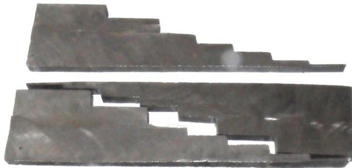
Slika 3.5. Segmenti izrezani iz sva tri stepenasta odljevka
