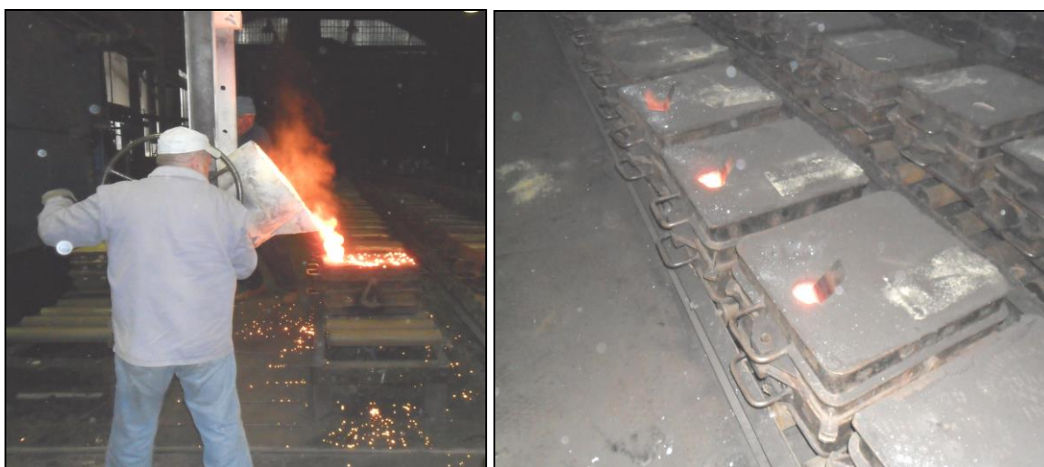
Slika 3.3. Lijevanje stepenastih odljevaka
