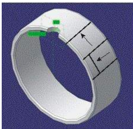
Slika 2. Lokacije uzimanja metalografskih uzoraka iz čahure
