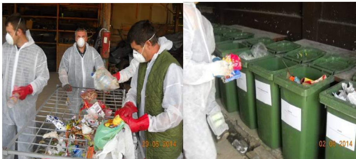
Slika 3. Analiza sastava komponenti komunalnog otpada
