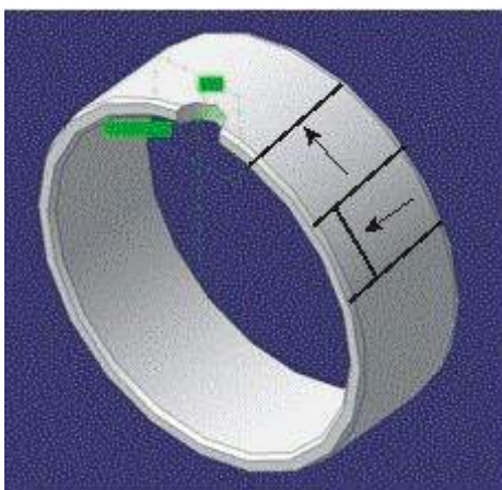
Slika 2. Lokacije uzimanja metalografskih uzoraka iz čahure
