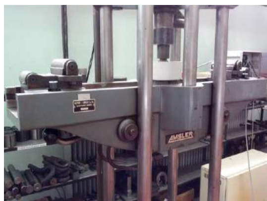
Slika 1. Pozicionirana mjerna ćelija u kidalici
