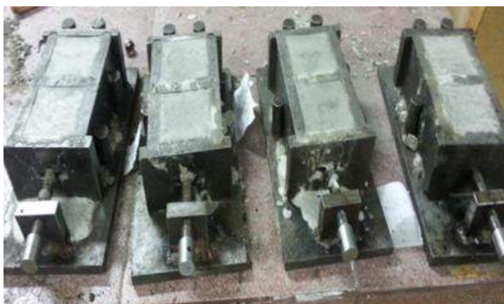
Slika 2. Prizmatični uzorci za ispitivanje pritiskne čvrstoće prema normi EN 12390-3
