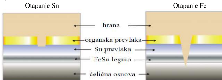
Slika 4. Interakcija hrane i ambalaže od bijelog lima kroz pore u zaštitnoj prevlaci
