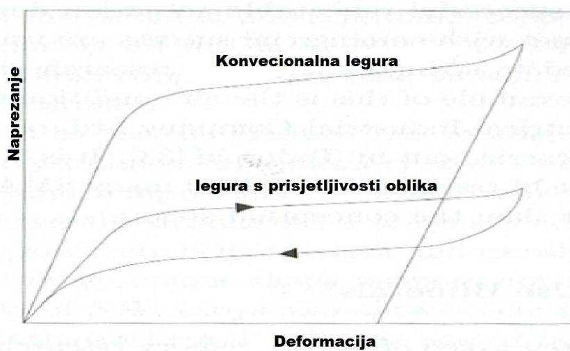
Slika 12. Shematski prikaz dijagrama naprezanje-deformacija za dvije različite legure [1]
