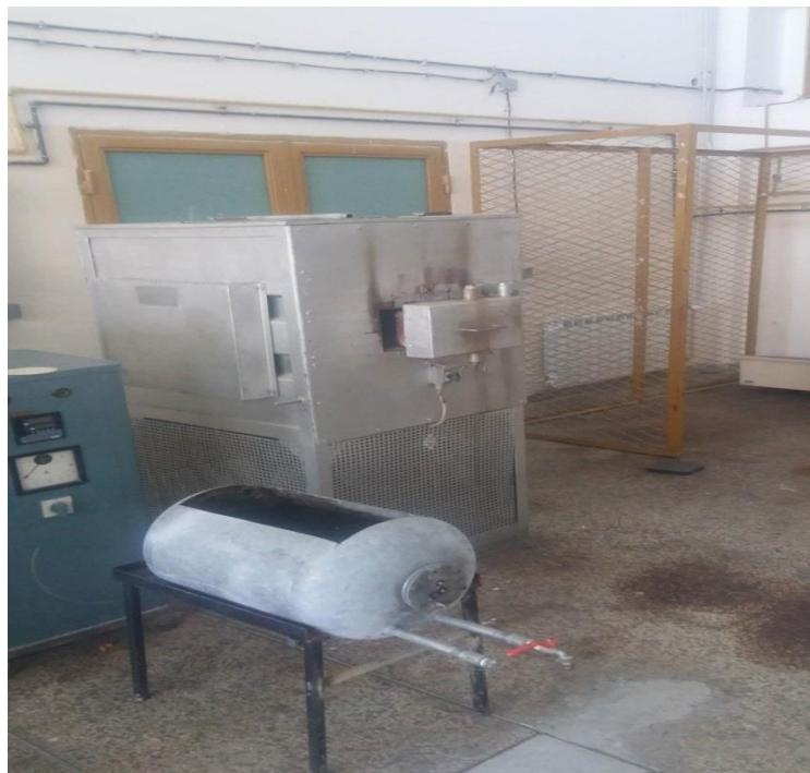
Slika 22. Fotografija elektrootporne komorne peći za žarenje
