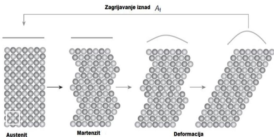
Slika 7. Shematski prikaz mehanizma efekta prisjetljivosti oblika [9]
