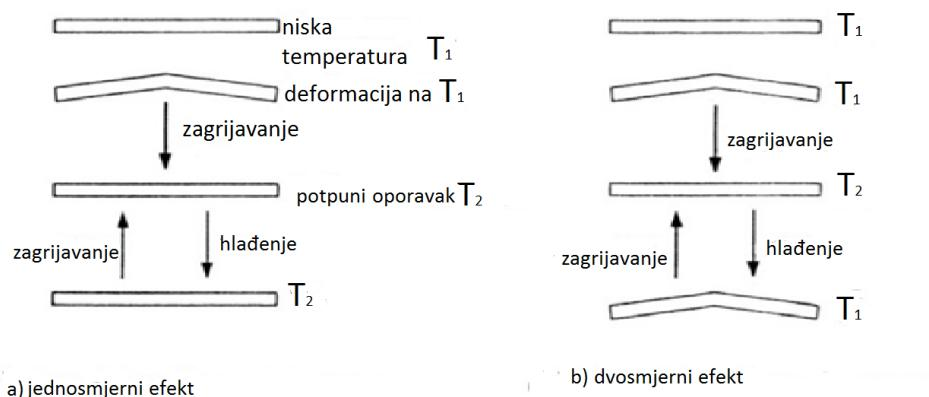
Slika 8. a) Shematski prikaz jednosmjernog efekta prisjetljivosti oblika; b) Shematski prikaz dvosmjernog efekta prisjetljivosti oblika [15]
