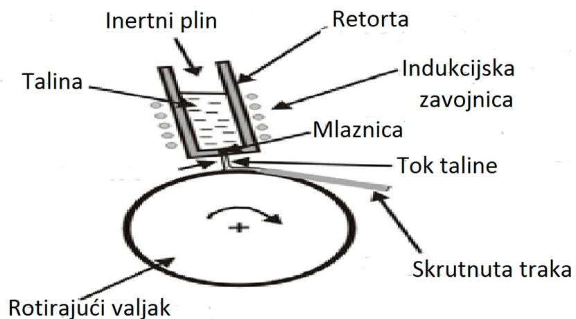
Slika 21. Shematski prikaz proizvodnje brzo skrnutnih Cu-Al-Mn-(Ti) traka na „melt spinneru“
