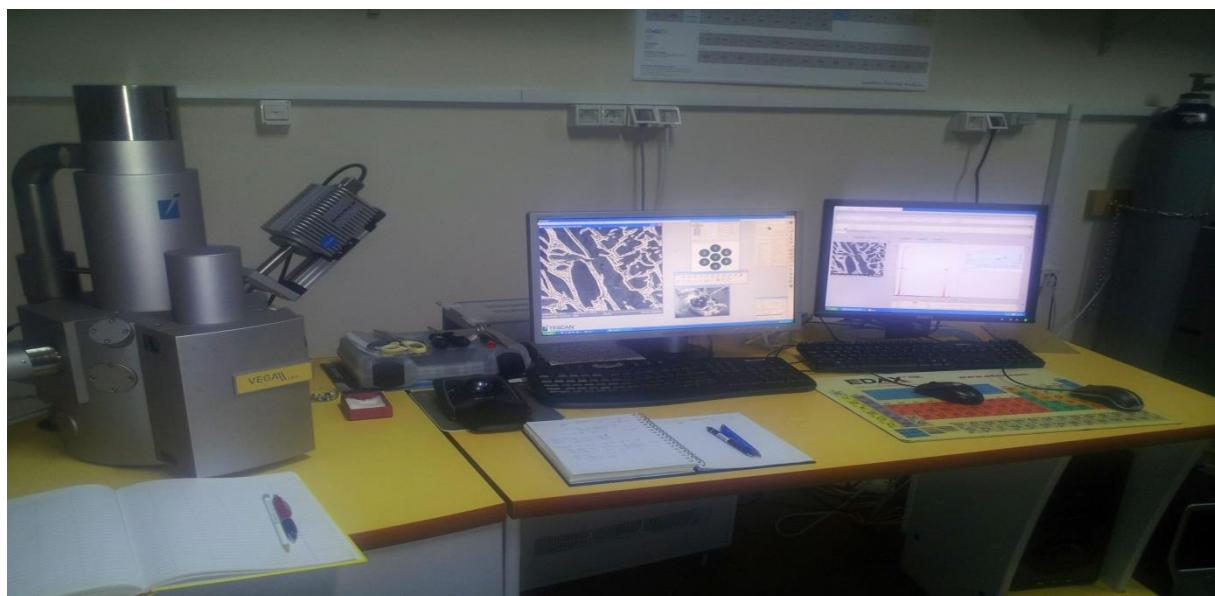
Slika 26. Fotografija pretražnog elektronskog mikroskopa TESCAN VEGA 5136 MM opremljenog uređajem za energetsko disperzijsku spektroskopiju (EDS)
