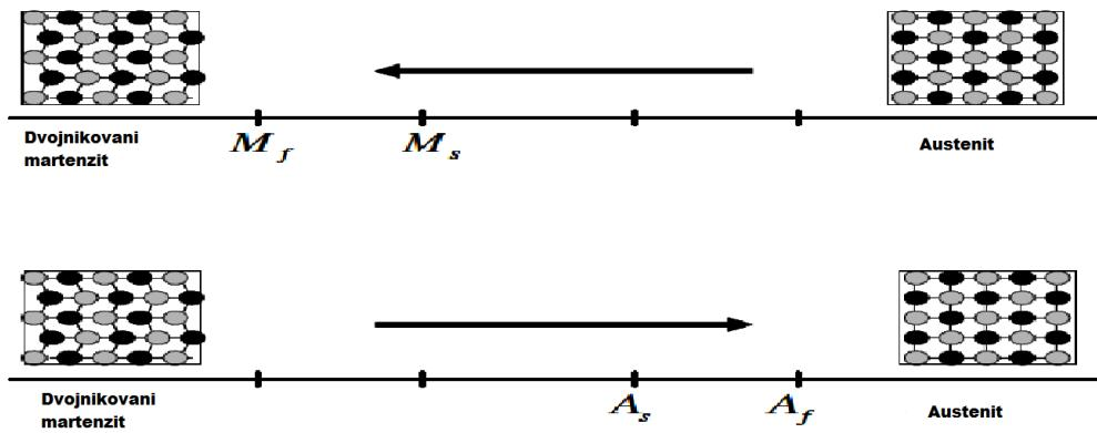
Slika 2. Fazna transformacija inducirana toplinom bez mehaničkog operećenja [7]
