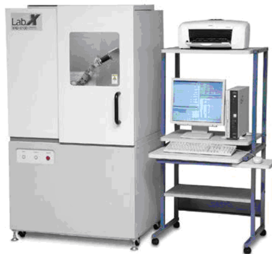
Slika 28. Fotografija uređaja za rendgensku faznu analizu Shimadzu 6000
