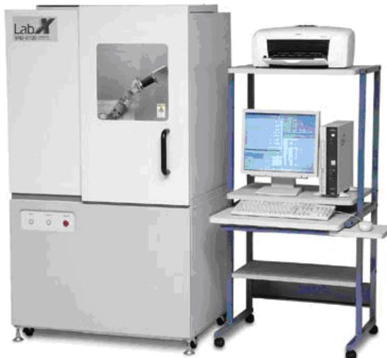
Slika 28. Fotografija uređaja za rendgensku faznu analizu Shimadzu 6000
