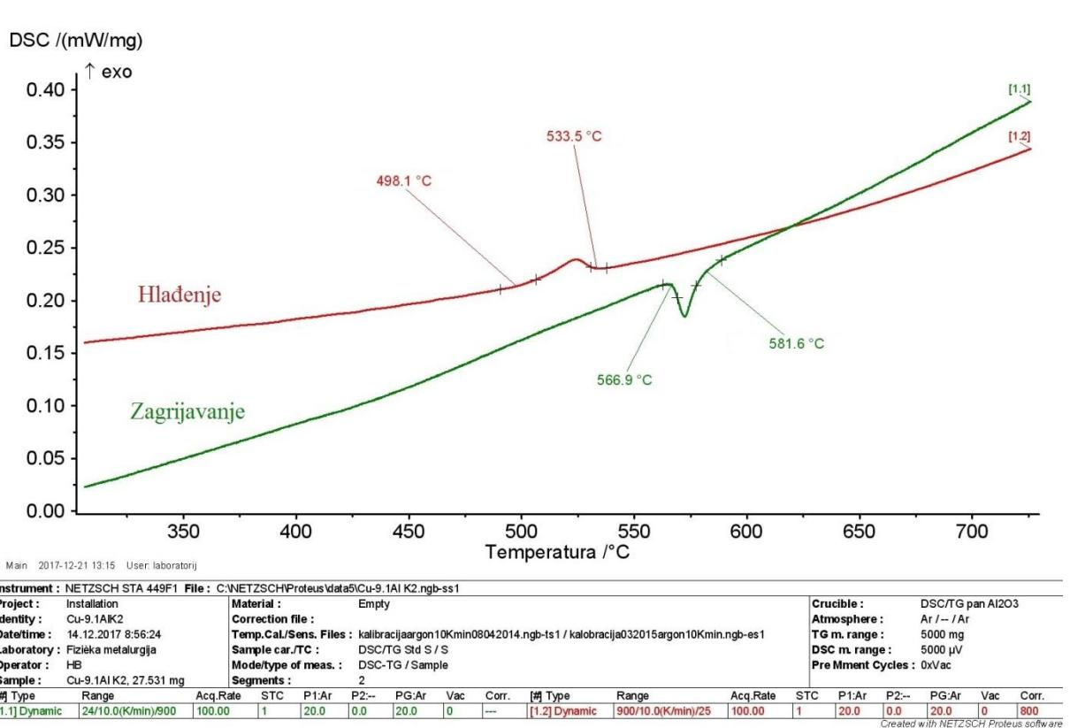
Slika 56. DSC krivulja zagrijavanja i hlađenja kaljenog uzorka K<sub>2</sub> (900 °C / 30 ' / H<sub>2</sub>O) Cu - 9,1Al legure
