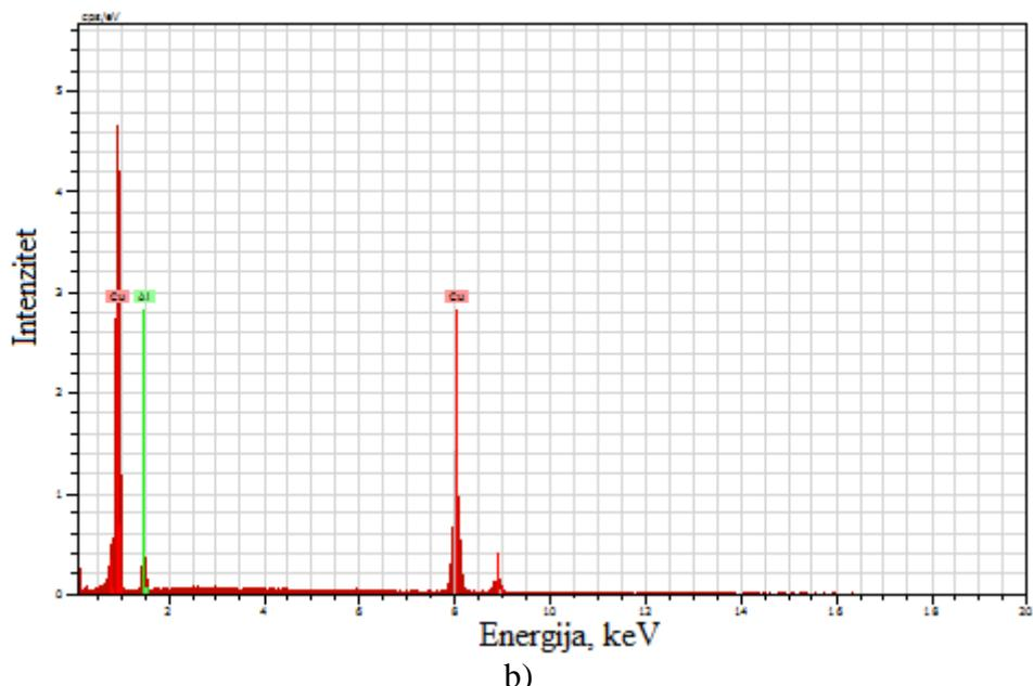
Slika 49. SEM mikrografija lijevane Cu - 9,1Al legure (a) kod povećanja 2000 X i energetsko disperzijski spektar (b) pozicije 2
