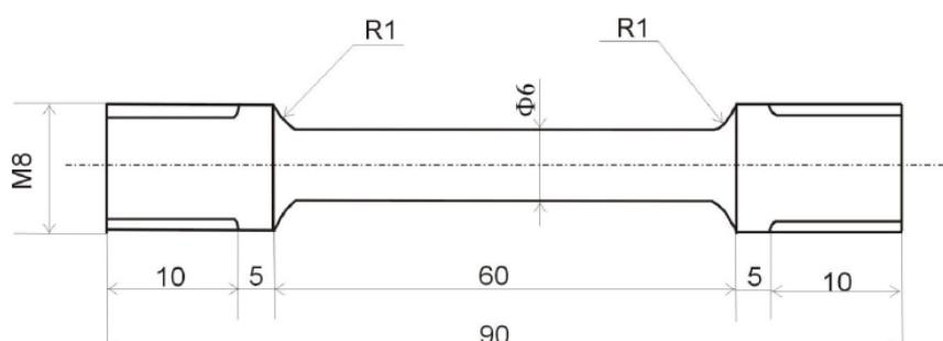
Slika 39. Shematski izgled epruvete za mehanička ispitivanja
