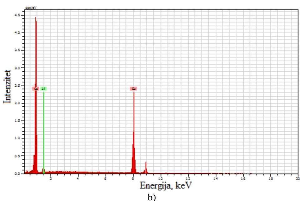
Slika 51. SEM mikrografija kaljenog uzorka  $K_1$  ( $900\text{ }^{\circ}\text{C} / 15'$  /  $\text{H}_2\text{O}$ ) Cu - 9,1Al legure (a) i energetsko disperzijski spektar (b) pozicije 2
