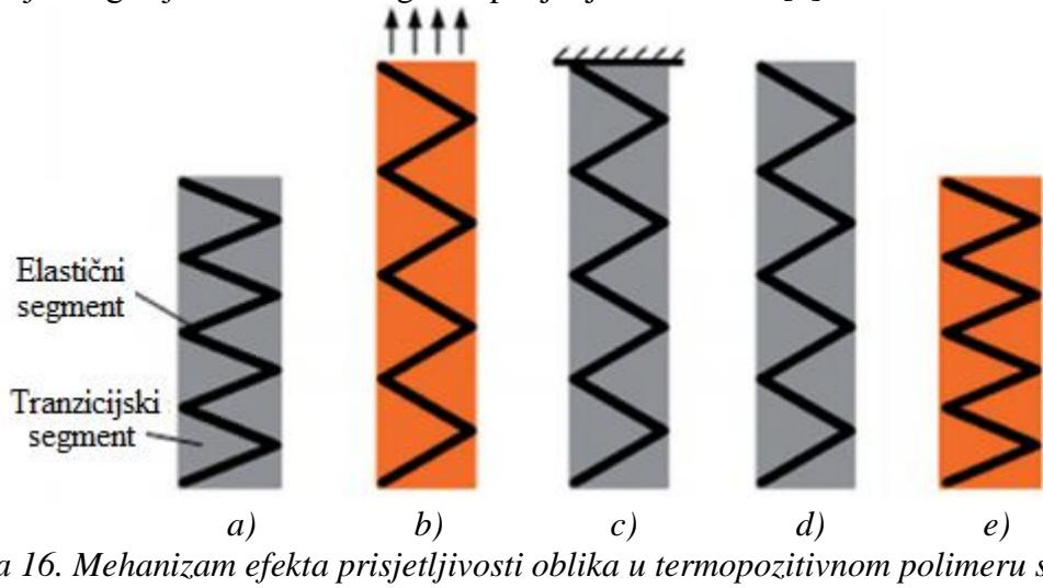
*Slika 16. Mehanizam efekta prisjetljivosti oblika u termopozitivnom polimeru s prisjetljivosti oblika: a) tvrd na niskoj temperaturi; b) mekan na visokoj temperaturi; c) ponovno tvrd nakon hlađenja; d) privremeni (deformirani) oblik; e) povratak u prvobitni oblik prilikom zagrijavanja*
