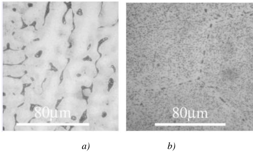
Slika 8. Prikaz mikrostrukture Cu - Al legure [10]: a) legura sastava 5 % Cu / 95 % Al, b) legura sastava 4 % Cu / 96 % Al nakon precipitacijskog očvršćavanja i gašenja [10]
