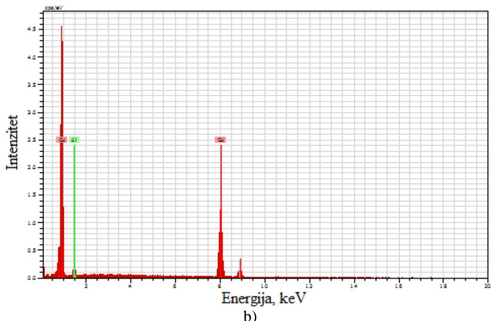
Slika 53. SEM mikrografija kaljenog uzorka K<sub>2</sub> (900 °C / 30 ' / H<sub>2</sub>O) Cu - 9,1Al legure (a) i energetsko disperzijski spektar (b) pozicije 2
