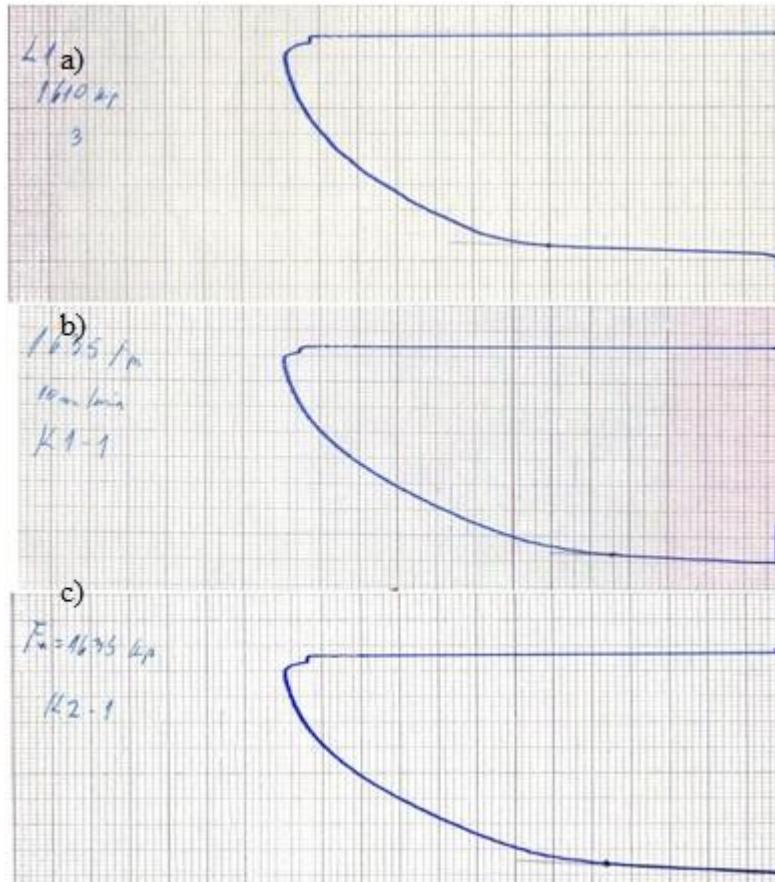
Slika 59. Dijagrami sila - produljenje dobivenih statičko vlačnim pokusom:
