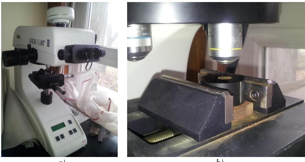
Slika 38. Mjerenje mikrotvrdoće: a) fotografija tvrdomjera Leica VMHT; b) postavljanje uzorka na nosač tvrdomjera i pregled njegove mikrostrukture pod povećanjem
