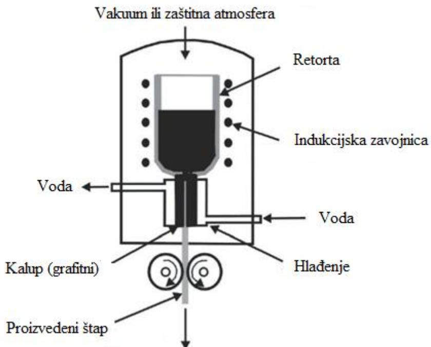
Slika 26. Shematski prikaz uređaja za kontinuirano vertikalno lijevanje
