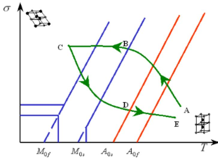
Slika 12. Prikaz pseudoelastičnog ponašanja legura s prisjetljivosti obliku prilikom termomehaničkog naprezanja [15]
