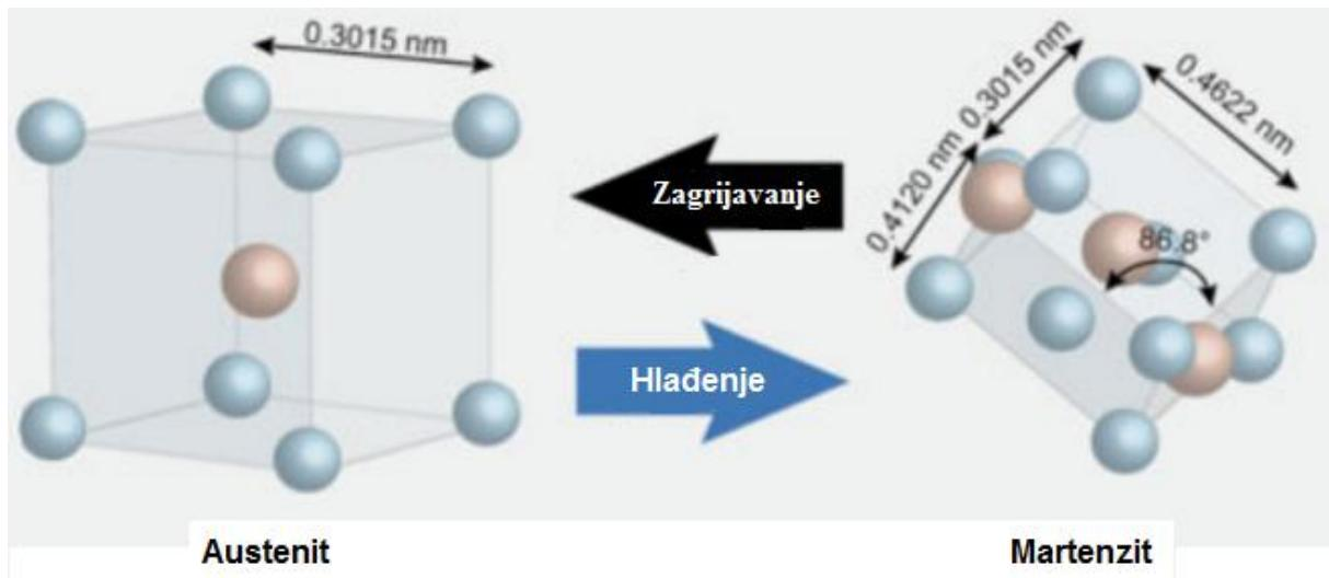
Slika 14. Shematski prikaz martenzitne transformacije u nitinol leguri [13]
