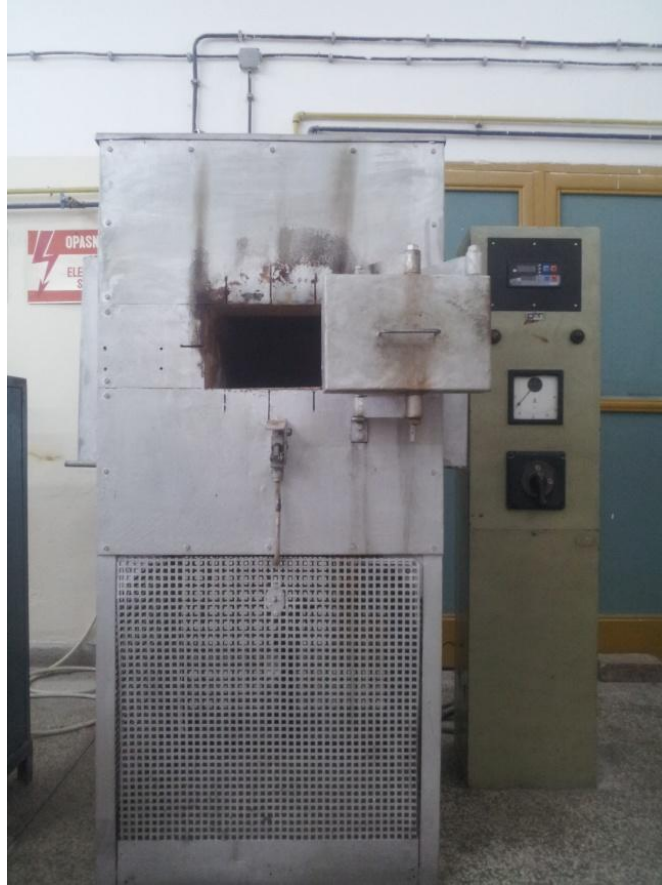
Slika 28. Fotografija elektrootporne komorne peći za žarenje
