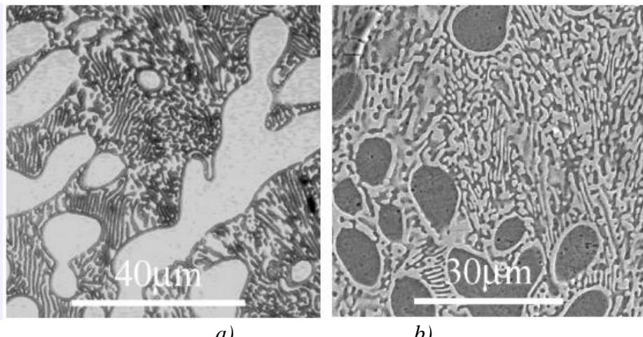
Slika 6. *Hipoeutektički sastav 25 % Cu / 75 % Al legure - Prikaz primarne faze aluminija u obliku dendrita (bijelo područje) [10]: a) optička mikroskopija, b) pretražna elektronska mikroskopija*
