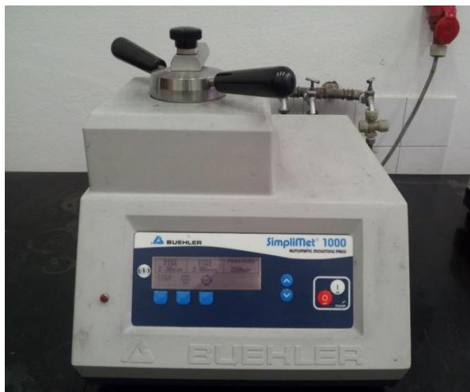
*Slika 31. Fotografija uređaja Simplimet® 1000 proizvođača Buehler*
