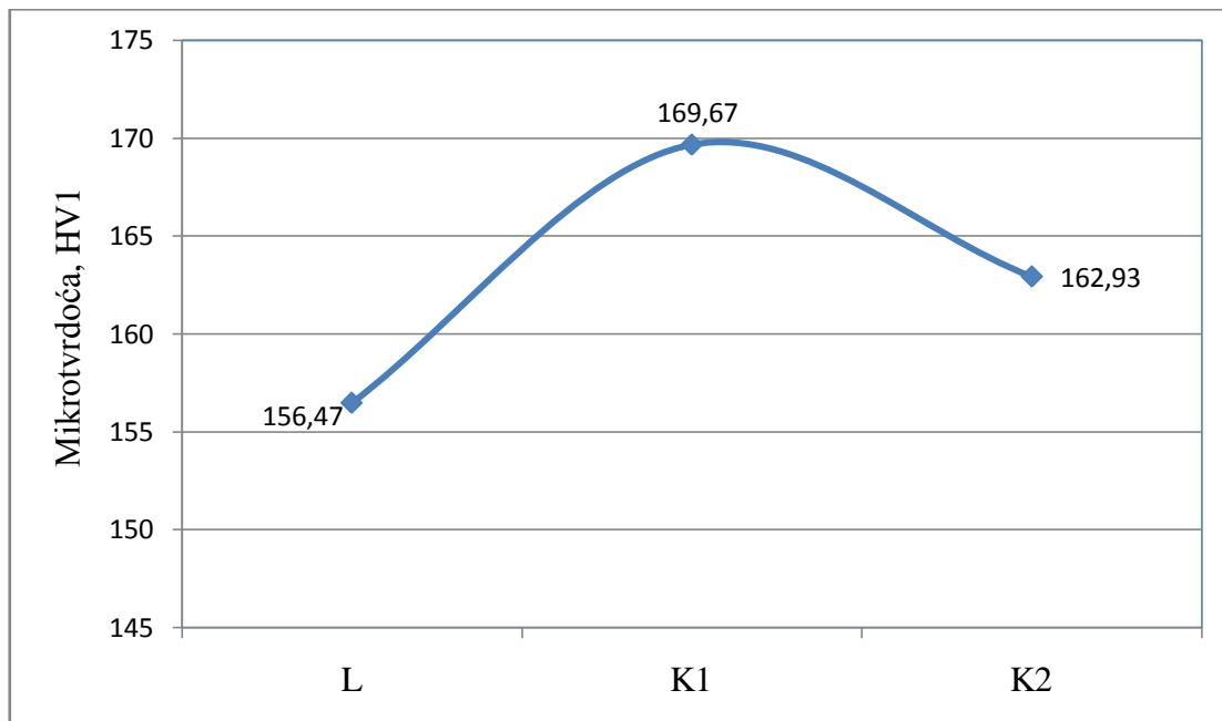
Slika 58. Ovisnost mikrotvrdoće Cu - 9,1Al legure o toplinskoj obradi:
