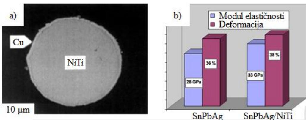
Slika 25. Primjena Ni - Ti legure u Sn - Pb - Ag leguri za lemljenje [31]:
