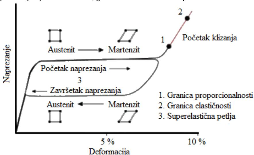
Slika 13. Shematski prikaz superelastične transformacije nitinola [13]
