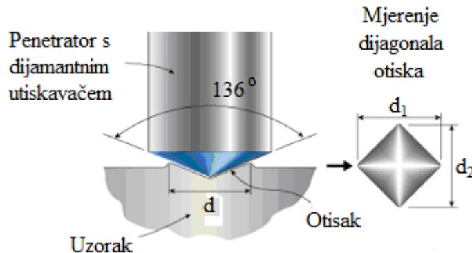
*Slika 37. Shematski prikaz mjerena mikrotvrdoće metodom po Vickersu [38]*
