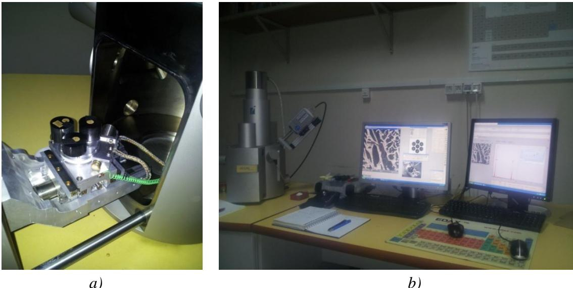
*Slika 35. Fotografija pretražnog elektronskog mikroskopa (SEM) Tescan VEGA 5136 MM LSH*
