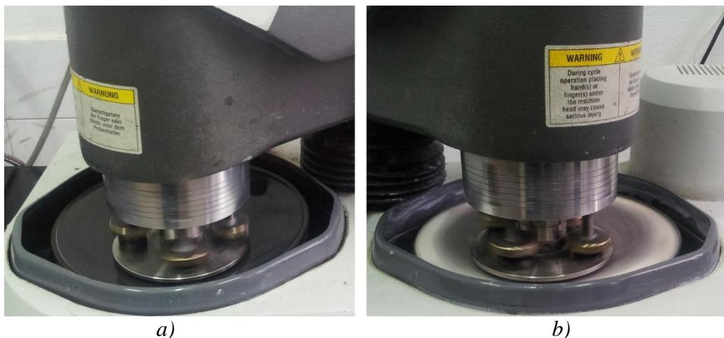
*Slika 33. Fotografija uređaja Phoenix Beta proizvođača Buehler za metalografsku pripremu:*
