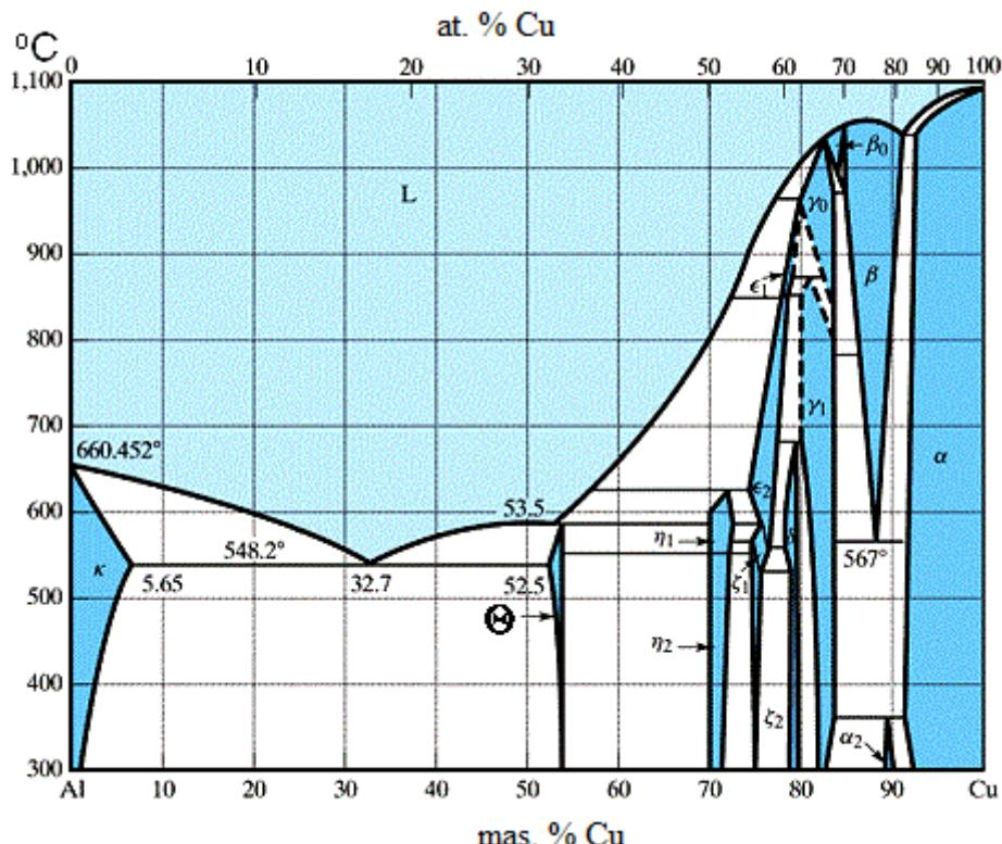
Slika 3. Fazni dijagram dvokomponentnog sustava Cu - Al [8, 9]
