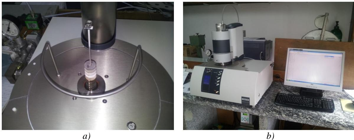
*Slika 36. Fotografija uređaja za simultanu toplinsku analizu STA DSC / TG
