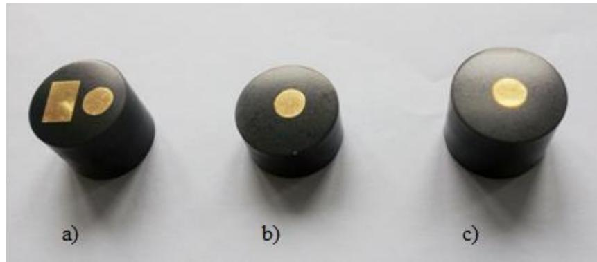
*Slika 32. Fotografije uzoraka uloženih toplim postupkom u vodljivu masu KonductoMet:*
