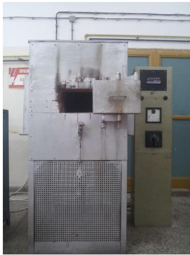
Slika 28. Fotografija elektrootporne komorne peći za žarenje
